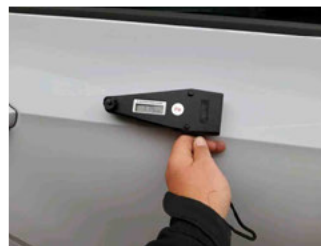
Lackstärke Seitenwand hinten rechts
