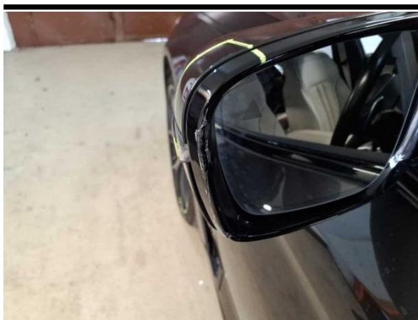
Beschädigung #14: Außenspiegel links: Spiegelgehäuse - beschädigt - erneuern
