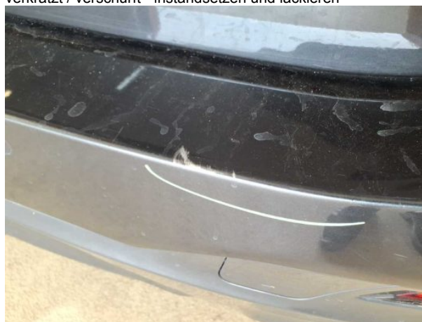
Beschädigung #18: Stossfänger hinten: Stossfänger hinten - verkratzt / verschürft - instandsetzen und lackieren
