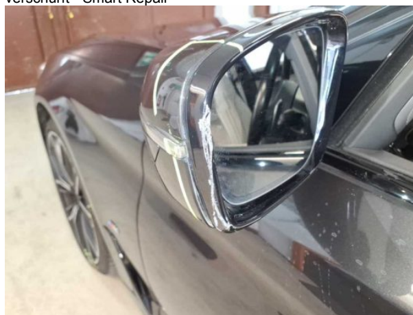
Beschädigung #14: Außenspiegel links: Spiegelgehäuse - beschädigt - erneuern
