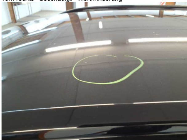
Beschädigung #4: Fahrzeugdach: Dach - Delle(n) - sanft instandsetzen
