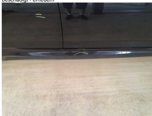
Beschädigung #16: Schweller rechts: Verkleidung - verkratzt / verschürft - instandsetzen und lackieren
