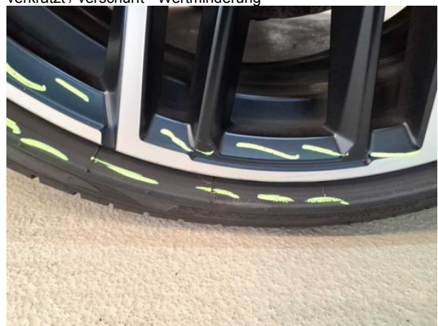
Beschädigung #10: Rad/Reifen: Leichtmetallfelge vorn recht... verkratzt / verschürft - Wertminderung
