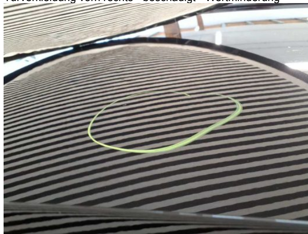
Beschädigung #4: Fahrzeugdach: Dach - Delle(n) - sanft instandsetzen
