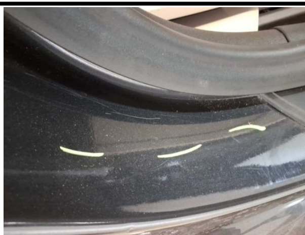
Beschädigung #11: Schweller rechts: Einstieg - verkratzt / verschürft - Smart Repair
