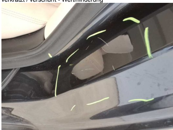
Beschädigung #7: Seitenwand links: Einstieg - verkratzt / verschürft - Smart Repair
