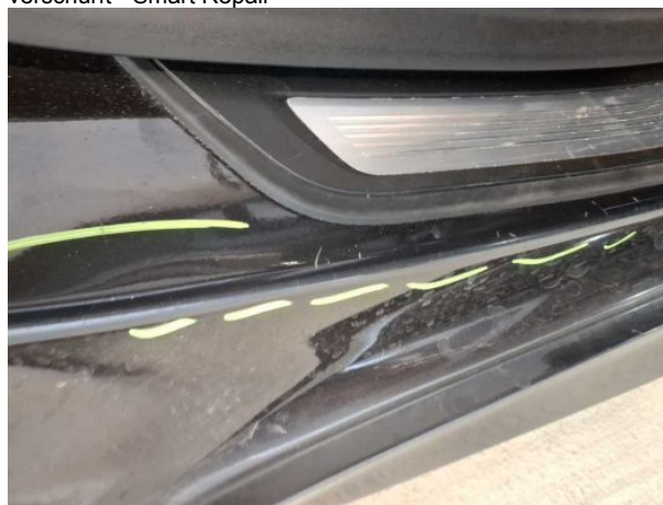
Beschädigung #12: Seitenwand rechts: Einstieg - verkratzt / verschürft - Smart Repair
