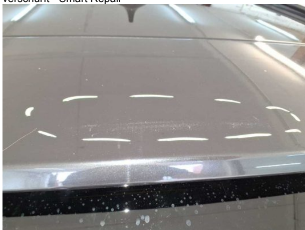
Beschädigung #13: Heckklappe/-tür: Heckspoiler - verkratzt / verschürft - Smart Repair
