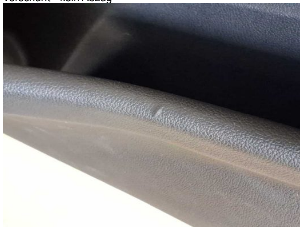
Beschädigung #3: Verkleidungen/Abdeckungen: Türverkleidung vorn rechts - beschädigt - Wertminderung
