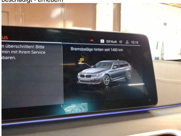
Beschädigung #15: Bremsanlage: Bremsscheiben und Beläge hinten - fällig - erneuern
