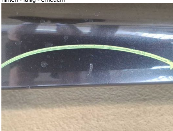
Beschädigung #16: Schweller rechts: Verkleidung - verkratzt / verschürft - instandsetzen und lackieren
