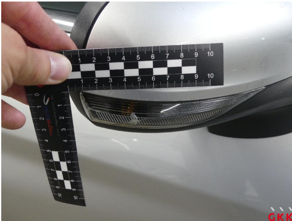
Bild 16 Spiegelgehäuse rechts, Blinker, zerbrochen, ersetzen
