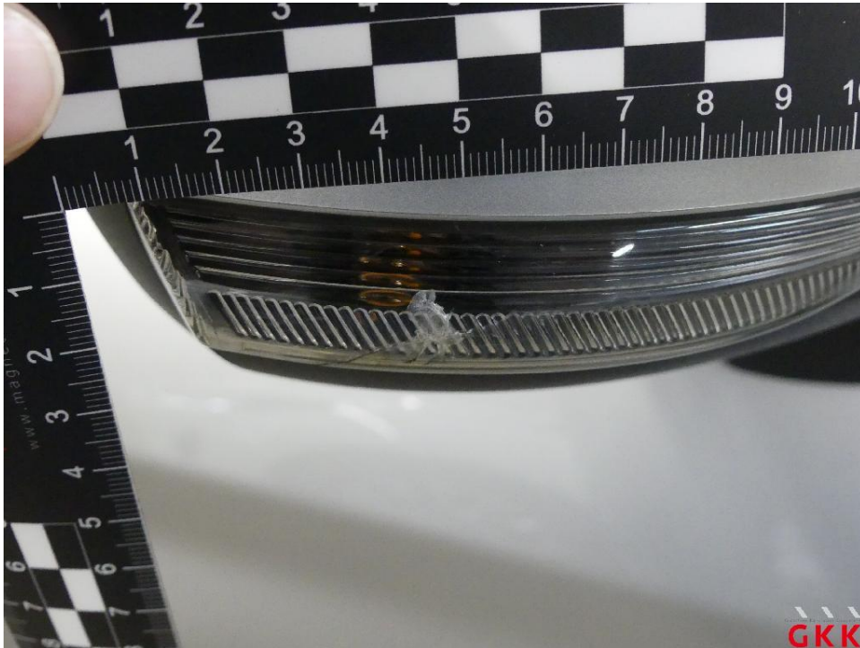
Bild 17 Spiegelgehäuse rechts, Blinker, zerbrochen, ersetzen
