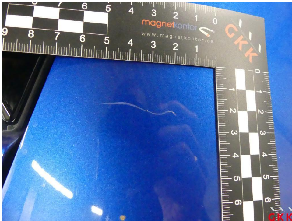
Bild 22 Seitenwand rechts, verkratzt, lackieren
