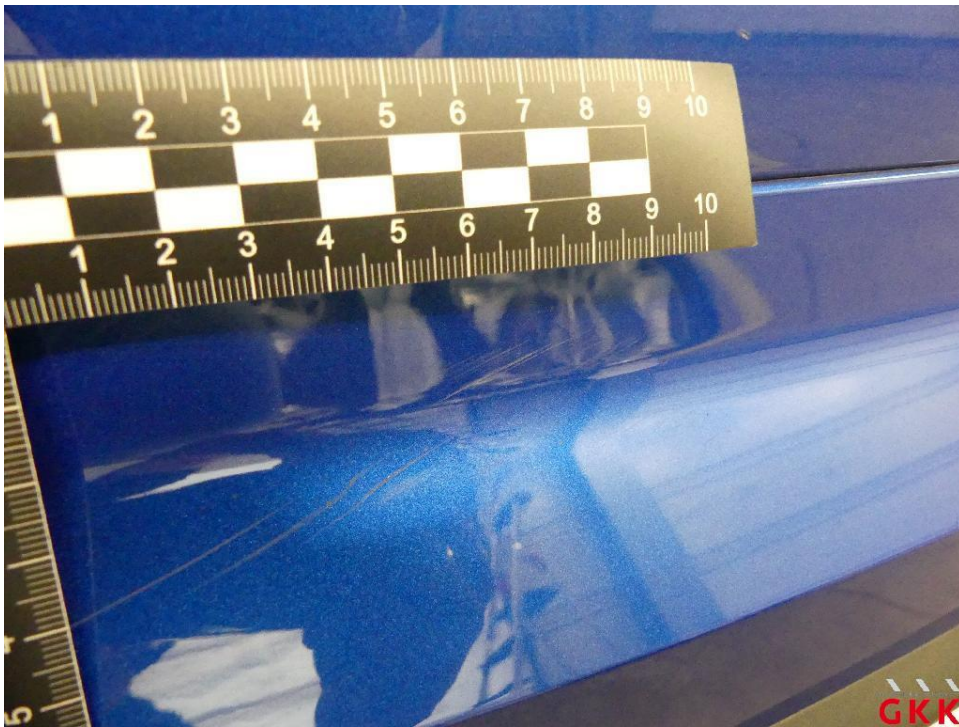
Bild 24 Stoßfänger hinten, Verkleidung oberhalb -lackiert-, verkratzt, lackieren
