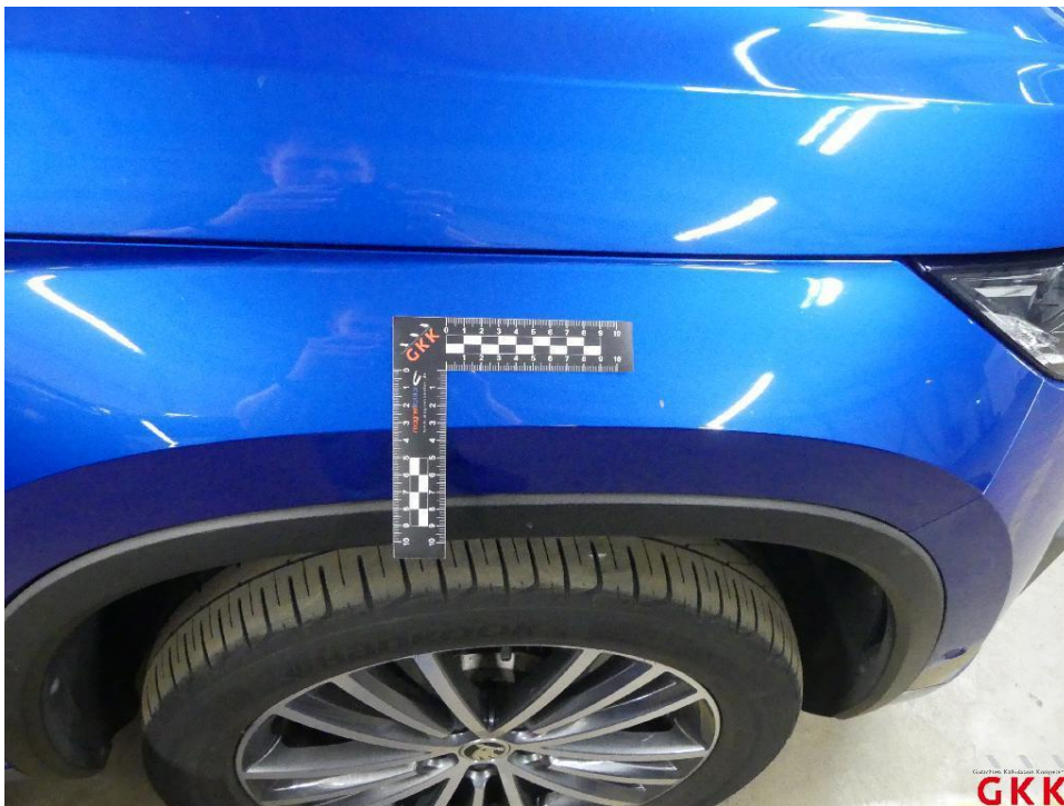
Bild 14 Kotflügel vorne rechts, verkratzt, lackieren
