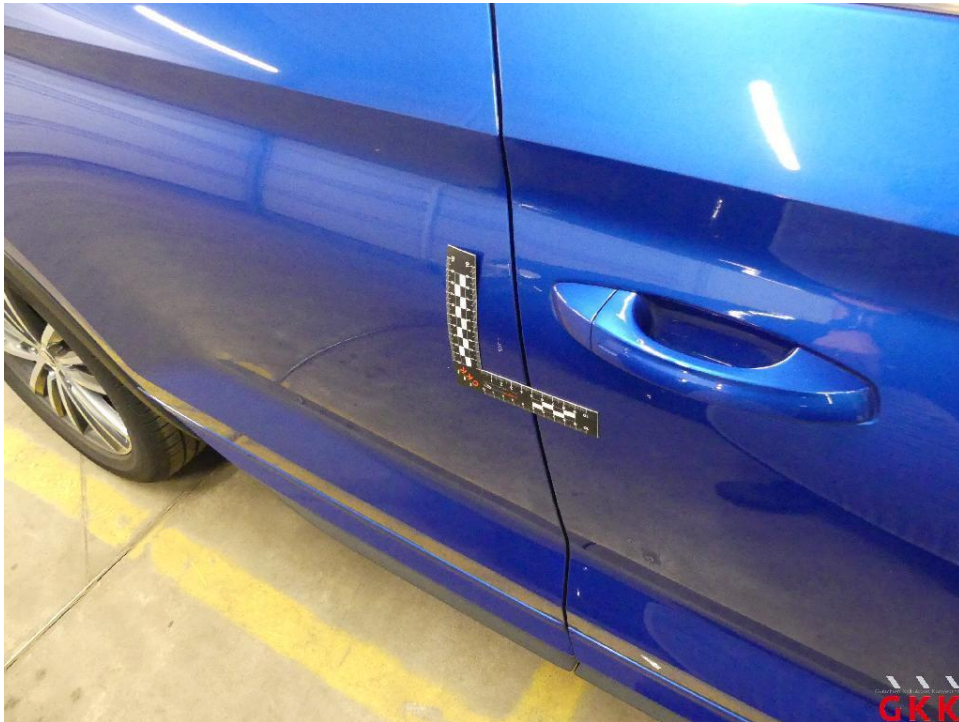
Bild 17 Tür hinten rechts, verkratzt, lackieren
