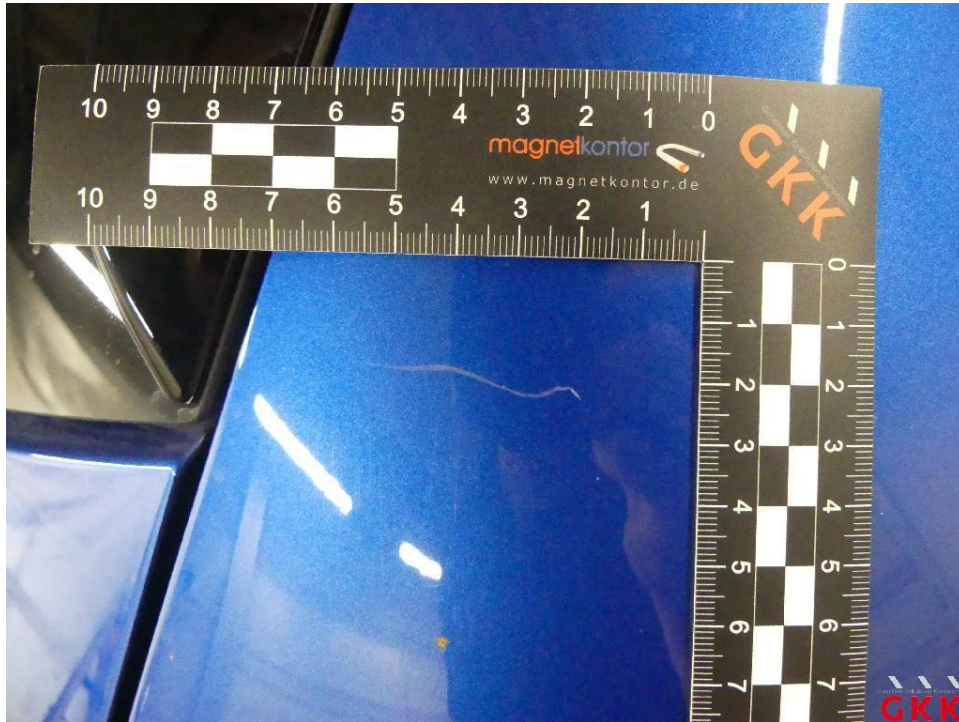
Bild 21 Seitenwand rechts, verkratzt, lackieren
