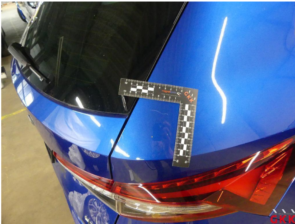
Bild 20 Seitenwand rechts, verkratzt, lackieren
