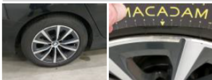
Velg alu A R gepolierd, Roest / Corrosie, Aanvaardbaar
