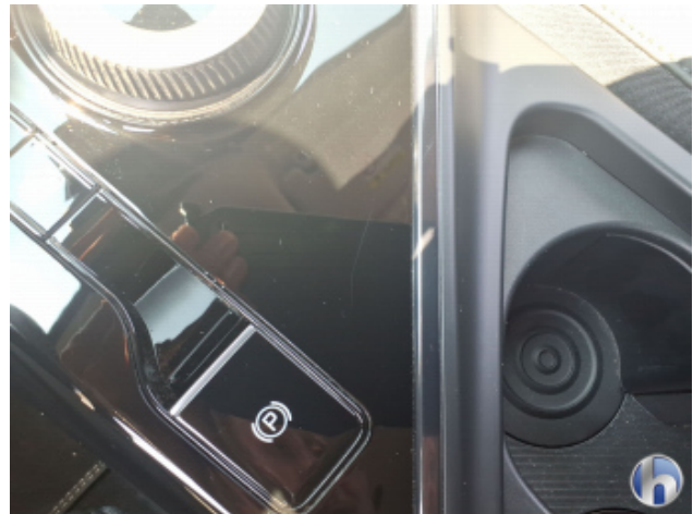
6. Mittelkonsole Innenraum vorne mitte Oberflächenkratzer - Aufbereiten / Polieren
