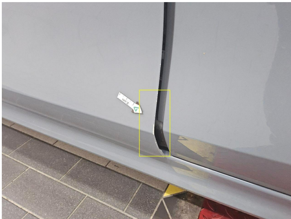
Bild 14 : Tür vorne links Kante, zerkratzt
