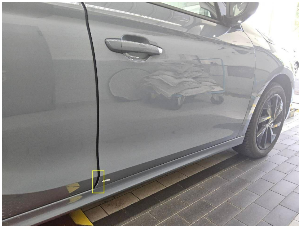
Bild 15 : Tür vorne rechts Kante, zerkratzt
