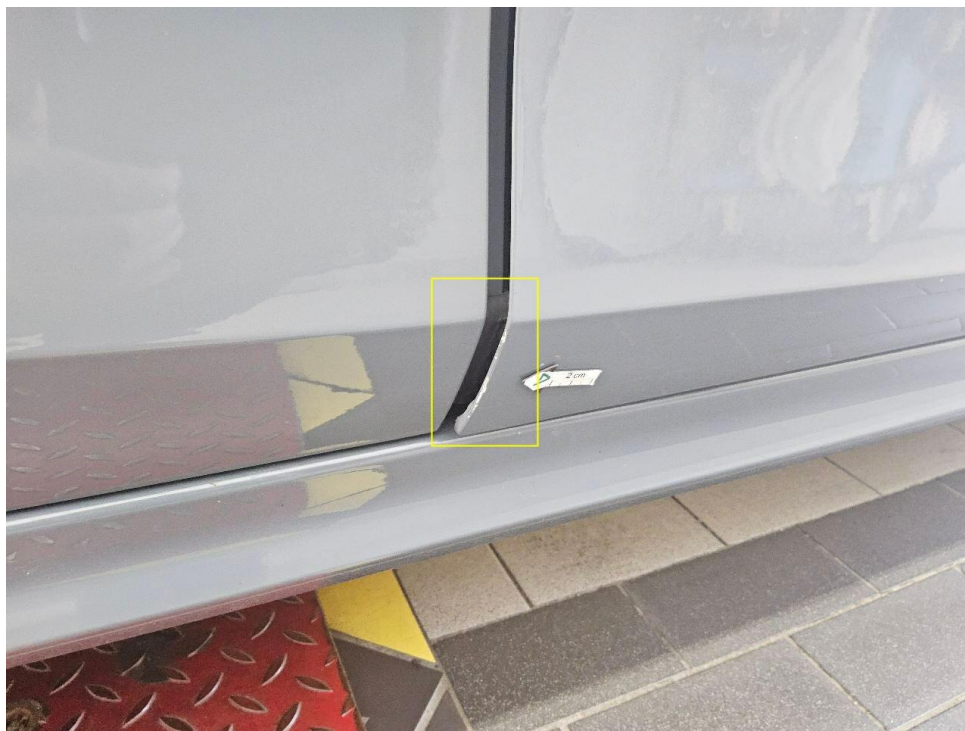
Bild 16 : Tür vorne rechts Kante, zerkratzt
