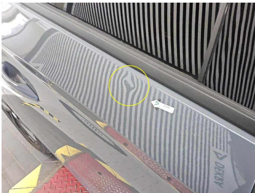
Bild 18 : Tür hinten rechts, eingedellt
