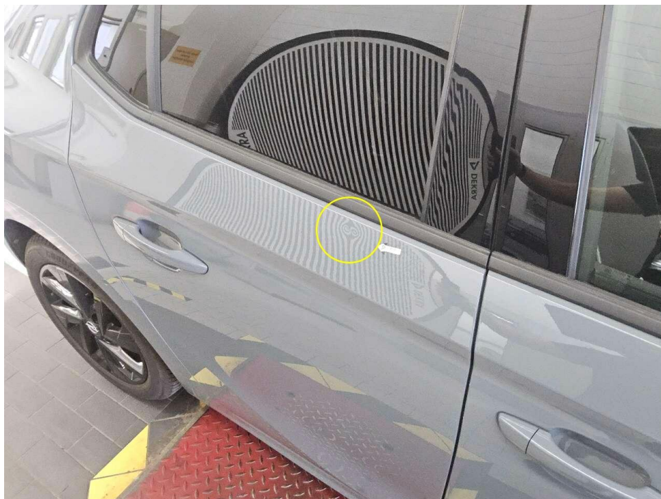
Bild 17 : Tür hinten rechts, eingedellt
