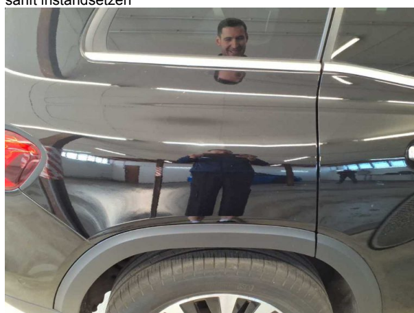
Beschädigung 6: Seitenwand rechts: Seitenwand - Delle(n) - sanft instandsetzen
