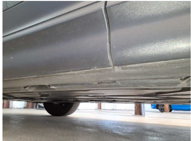
Gebrauchsspur 4: Tür vorn links: Zierleiste unten - verkratzt / verschürft - kein Abzug
