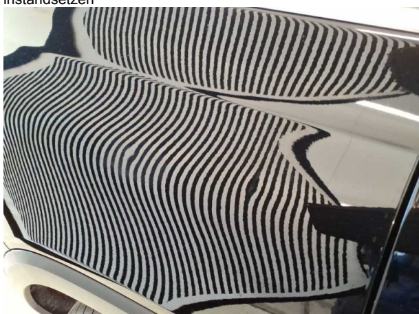
Beschädigung 6: Seitenwand rechts: Seitenwand - Delle(n) - sa... instandsetzen
