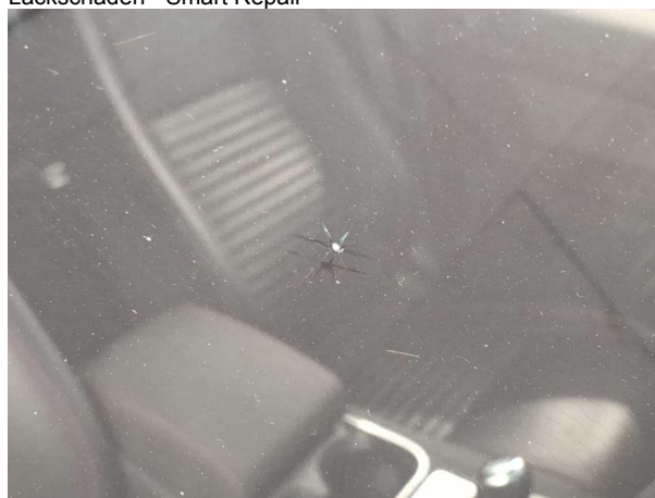
Beschädigung #5: Verglasung: Frontscheibe - Steinschlag - erneuern
