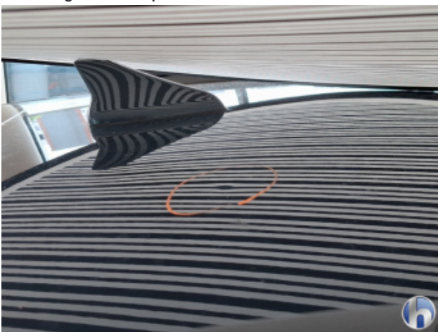
2. Dach 1 Delle - Sanft Instandsetzen
