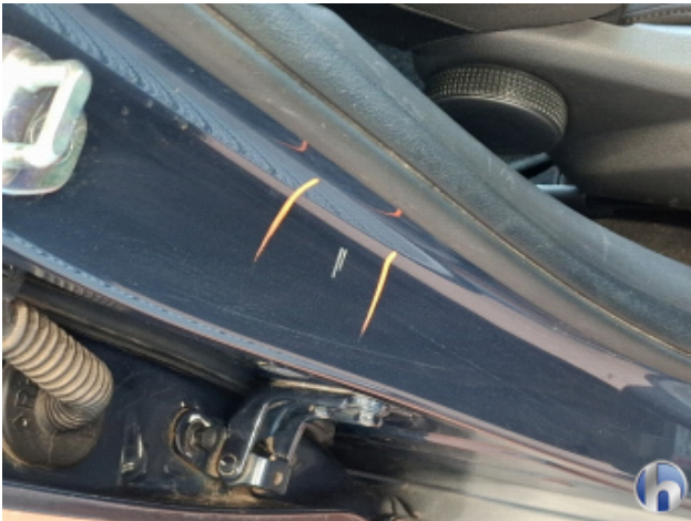
3. Türeinstieg Vorne - Rechts Beschädigt - Smart Repair
