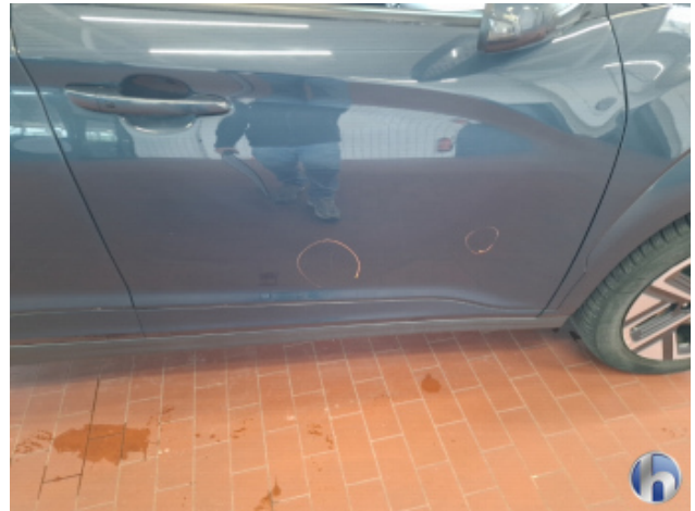
4. Tür Vorne - Rechts 2 Dellen - Sanft Instandsetzen
