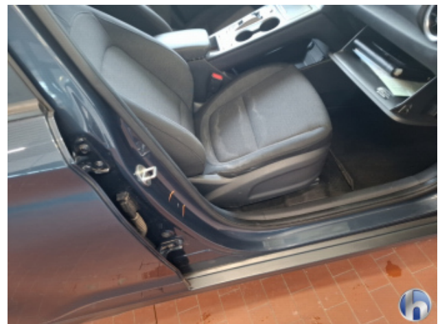
3. Türeinstieg Vorne - Rechts Beschädigt - Smart Repair
