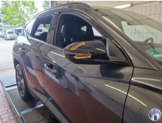
1. Außenspiegel Gehäuse - Rechts Beschädigt - Erneuern
