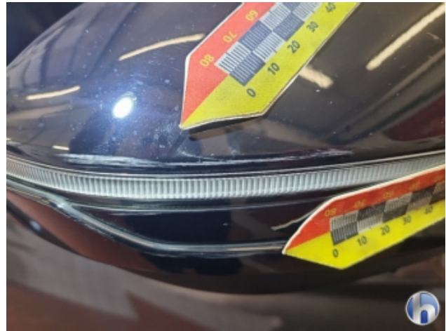
1. Außenspiegel Gehäuse - Rechts Beschädigt - Erneuern
