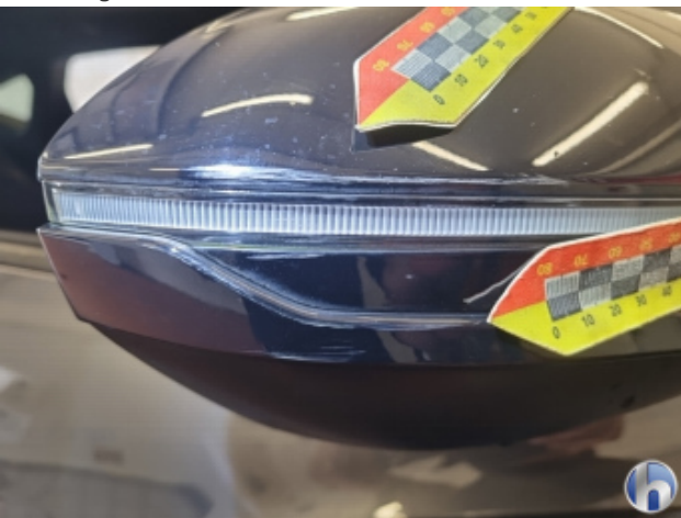
1. Außenspiegel Gehäuse - Rechts Beschädigt - Erneuern
