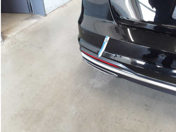
Beschädigung #4: Stossfänger hinten: Spoiler - verkratzt / verschürft - erneuern
