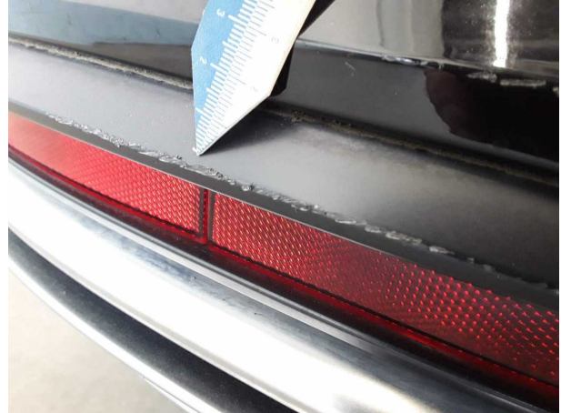
Beschädigung #4: Stossfänger hinten: Spoiler - verkratzt / verschürft - erneuern
