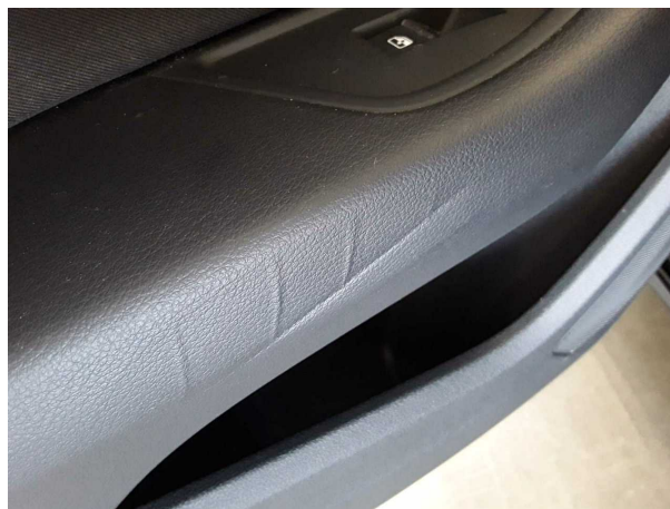
Beschädigung #1: Verkleidungen/Abdeckungen: Türverkleidung hinten links - verformt - Wertminderung
