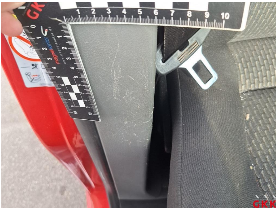
Bild 12. B- Säule rechts, Innenverkleidung -unterhalb-, verkratzt, ersetzen
