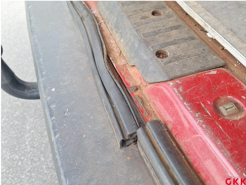
Bild 22. Laderaum, Dichtung, beschädigt, ersetzen
