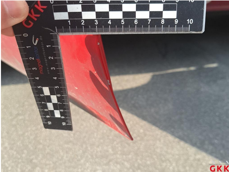
Bild 17. Tür vorne links, Kante, verkratzt, auslegen, schleifen, polieren
