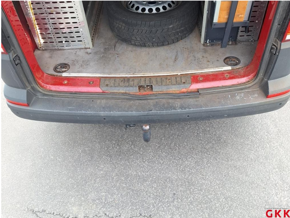
Bild 21. Laderaum, Dichtung, beschädigt, ersetzen
