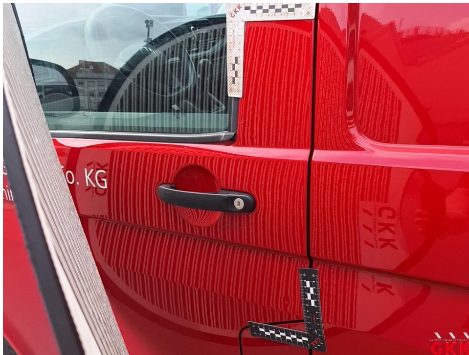
Bild 32. Tür vorne links, bis 3 Dellen / Bauteil, kalt drücken
