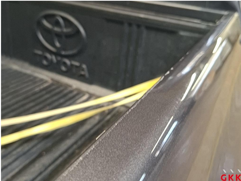
Bild 40 Seitenwand rechts, Klebreste, entfernen
