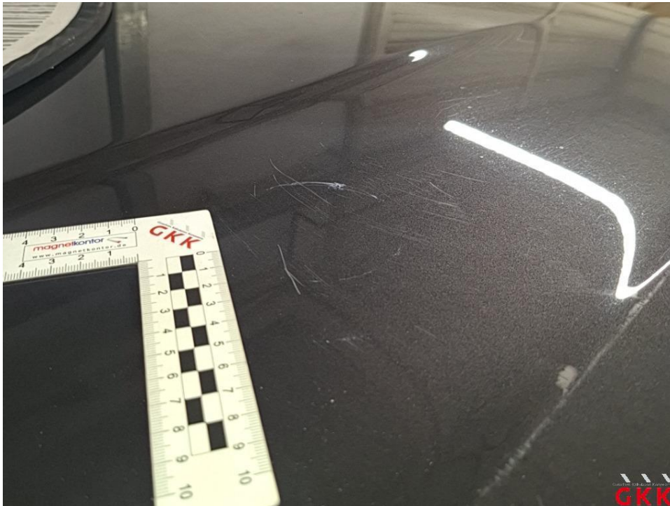
Bild 46 Dach, verkratzt, lackieren
