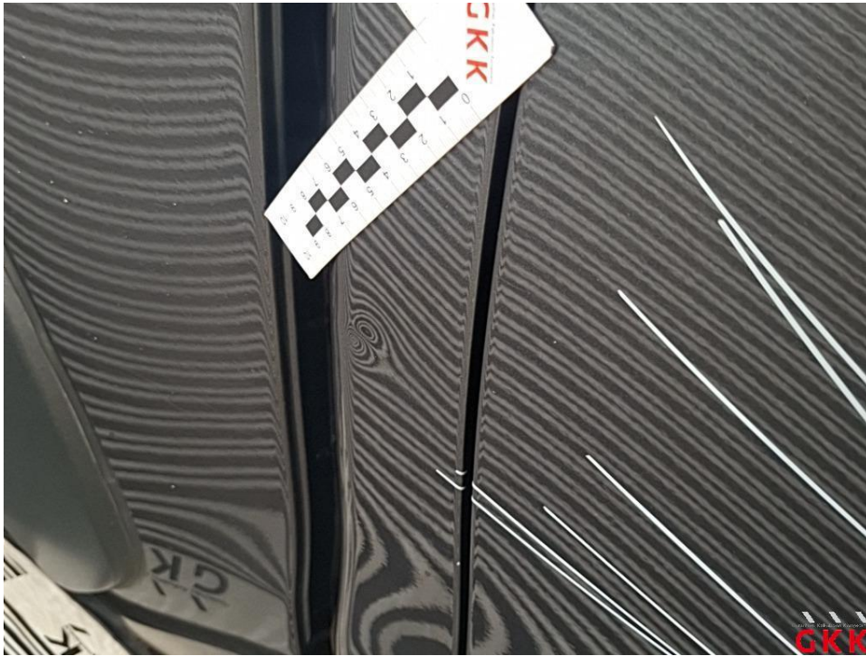
Bild 44 C- Säule rechts, beschädigt, Smartrepair
