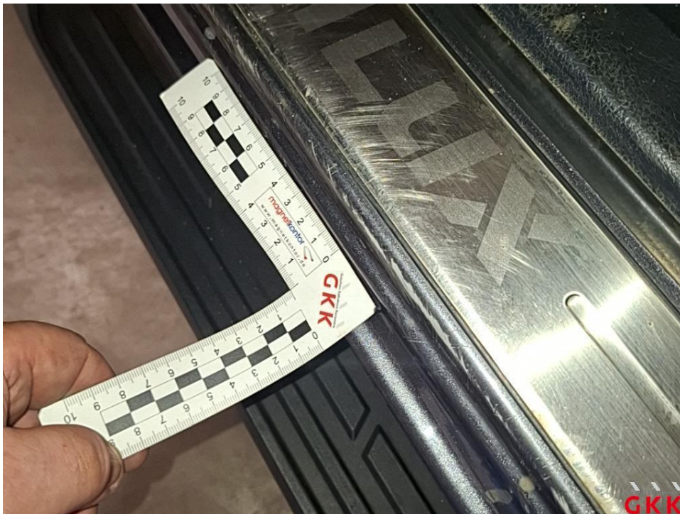
Bild 29 Tür vorne links, Einstieg, verkratzt, Spotlackieren
