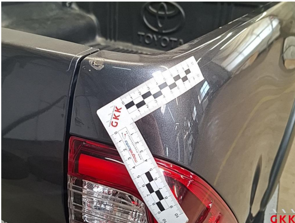
Bild 41 Seitenwand rechts, verkratzt, lackieren
