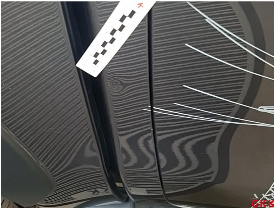
Bild 45 C- Säule rechts, beschädigt, Smartrepair
