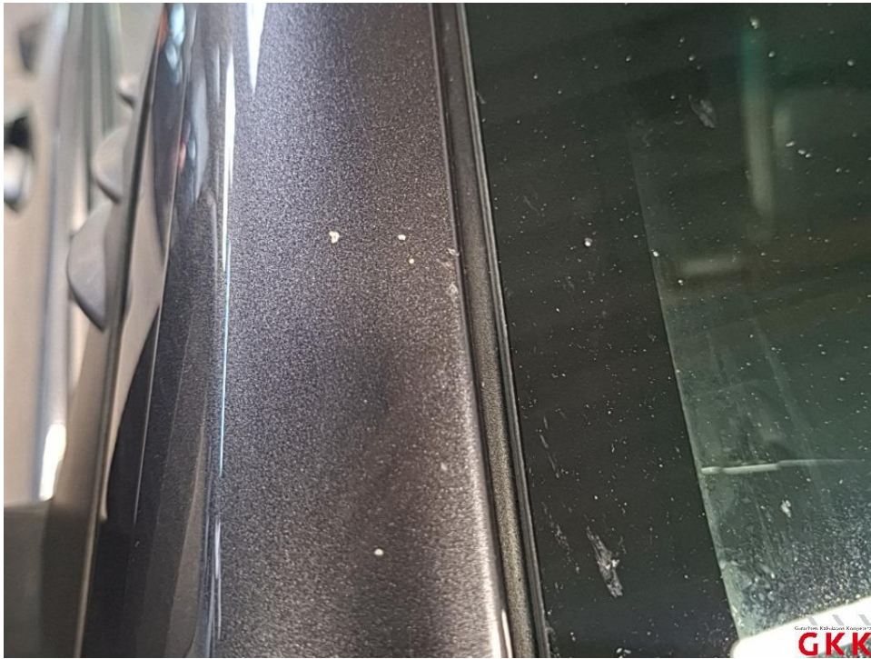
Bild 50 A- Säule rechts, Steinschlag, lackieren
