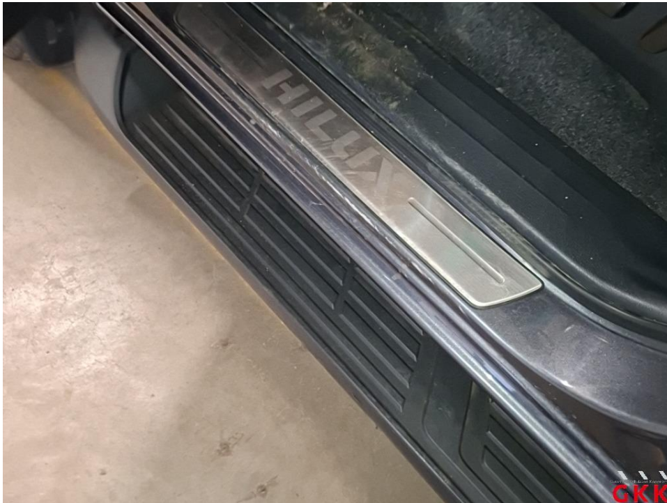
Bild 28 Tür vorne links, Einstieg, verkratzt, Spotlackieren
