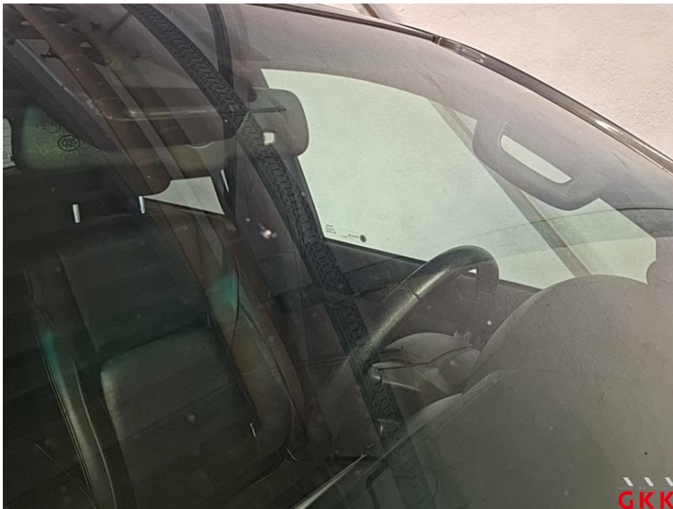
Bild 24 Frontscheibe, mit Regensensor und Frontkamera, Steinschlag mit Rissbildung, ersetzen
