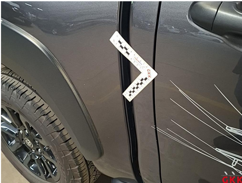
Bild 43 C- Säule rechts, beschädigt, Smartrepair
