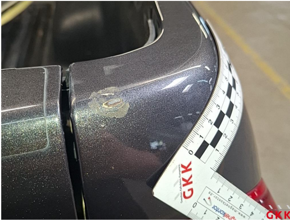
Bild 42 Seitenwand rechts, verkratzt, lackieren
