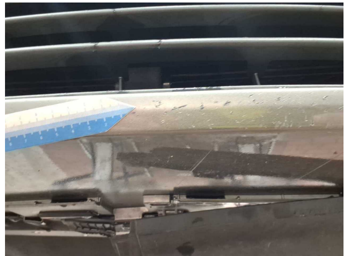
Damage 10: Front bumper: Front bumper (Halter + Spoiler (L/R) + Aufpralldämpfer erneuert) - Scratched - Paint
