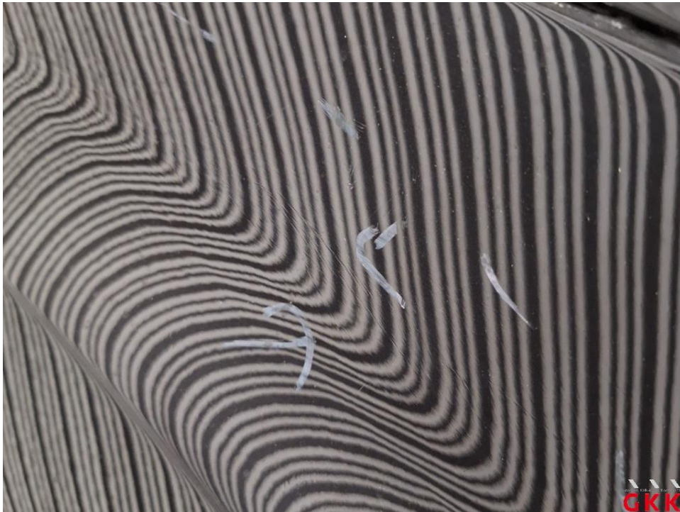
Bild 15 Seitenwand rechts, Reparaturmangel, lackieren
