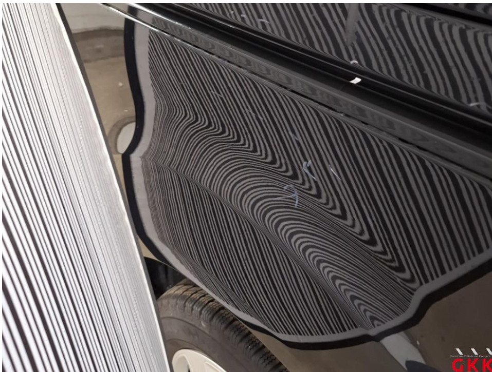
Bild 14 Seitenwand rechts, Reparaturmangel, lackieren
