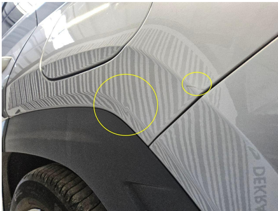
Bild 14 : Seitenwand hinten links eingedellt und verschrammt
