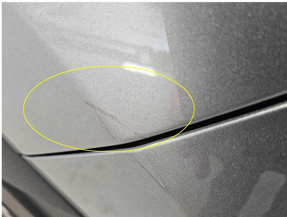
Bild 13 : Seitenwand hinten links eingedellt und verschrammt
