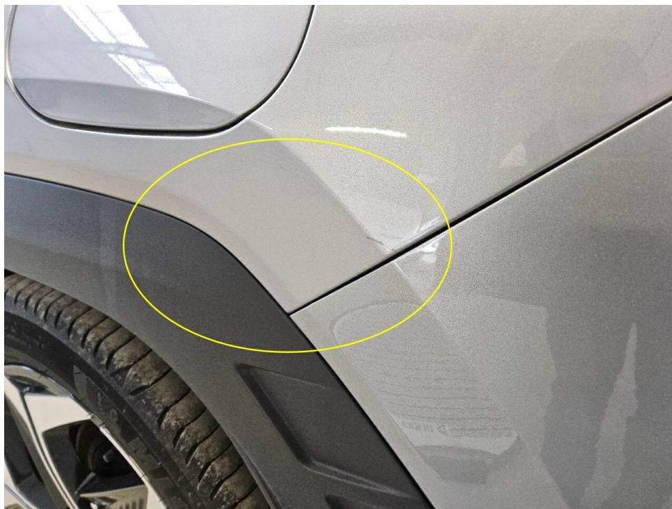
Bild 12 : Seitenwand hinten links eingedellt und verschrammt
