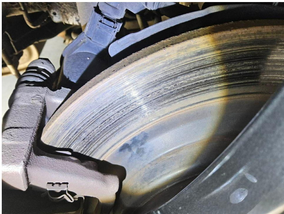
Bild 11 : Bremsscheiben Hinterachse Tragbild mangelhaft, Riefen-und Korrosionsbildung
