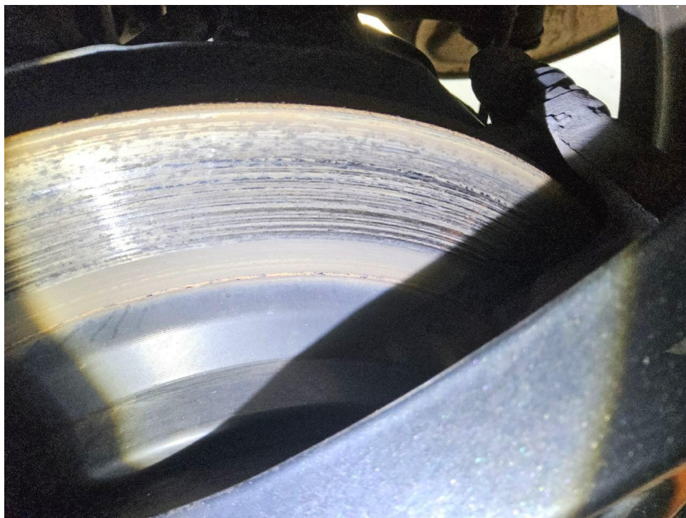
Bild 10 : Bremsscheiben Hinterachse Tragbild mangelhaft, Riefen-und Korrosionsbildung
