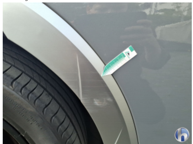
1. Tür Hinten - Rechts Kratzer - Erneuern
