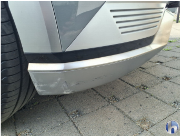
3. Stoßfänger Vorne Kratzer - Erneuern
