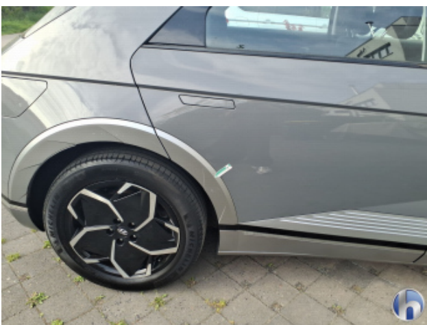
1. Tür Hinten - Rechts Kratzer - Erneuern
