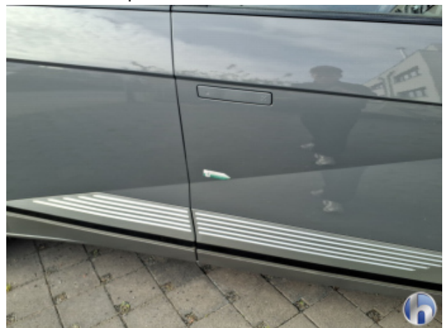
5. Tür Vorne - Rechts Kratzer - Smart Repair
