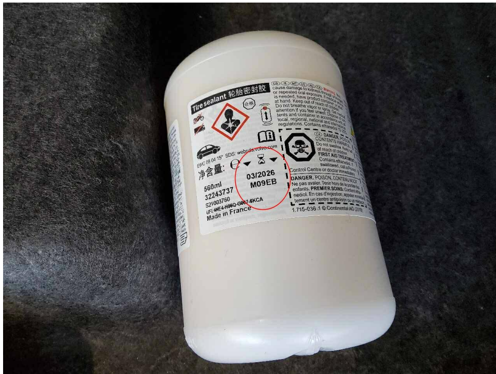
Bild 15 : Füllflasche Pannenset, abgelaufen (03/2026)
