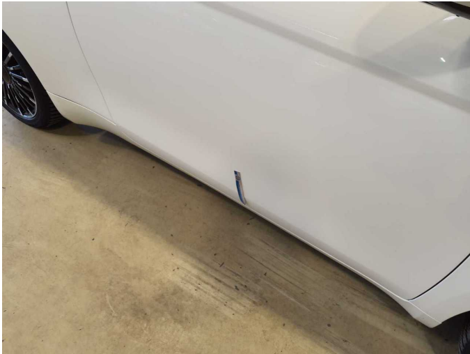
Damage 9: Door - front right side: Door - Scratch(es) - Paint
