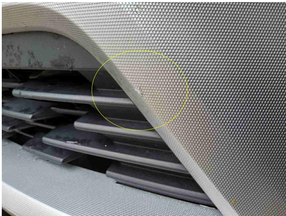
Bild 15 : Zierleiste Stoßfänger vorne verschrammt
