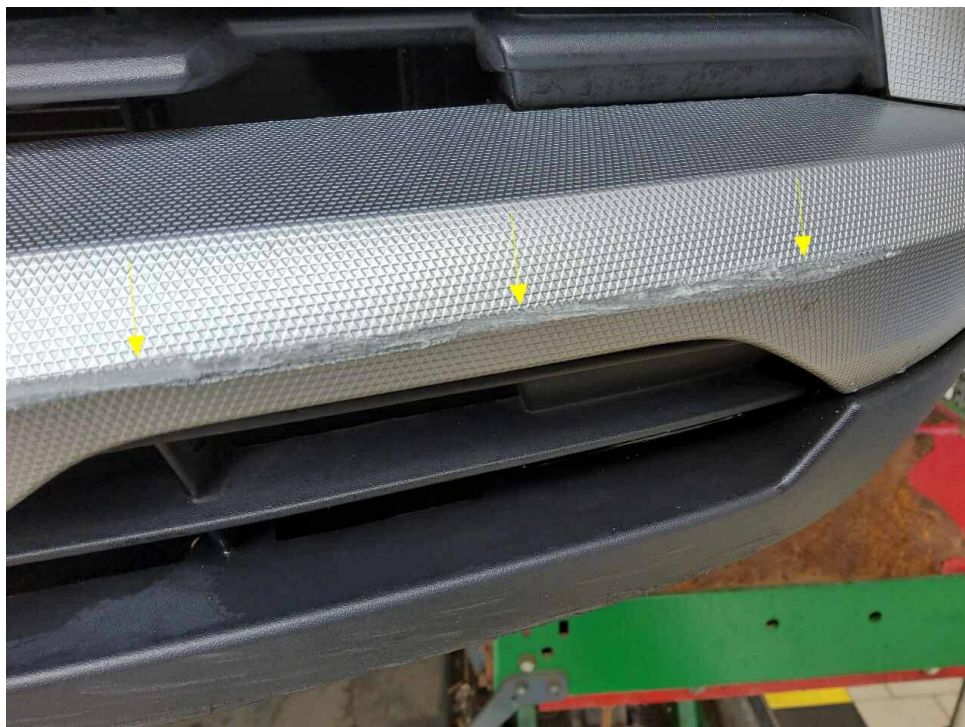
Bild 14 : Mittelblende Stoßfänger vorne verschrammt
