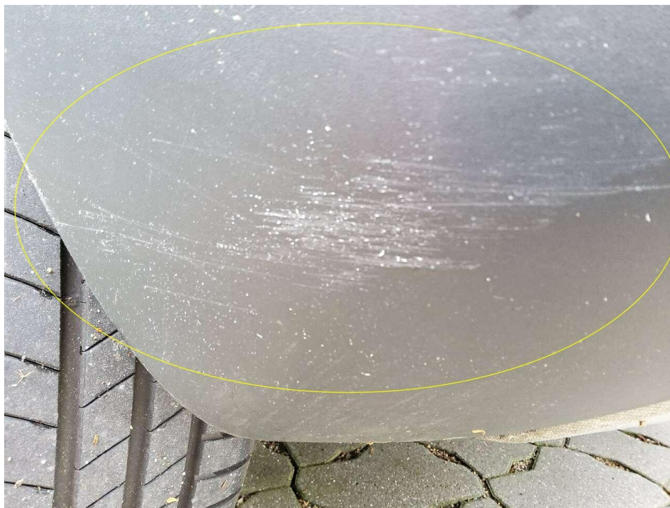
Bild 18 : Stoßfängerverkleidung hinten unterhalb verschrammt
