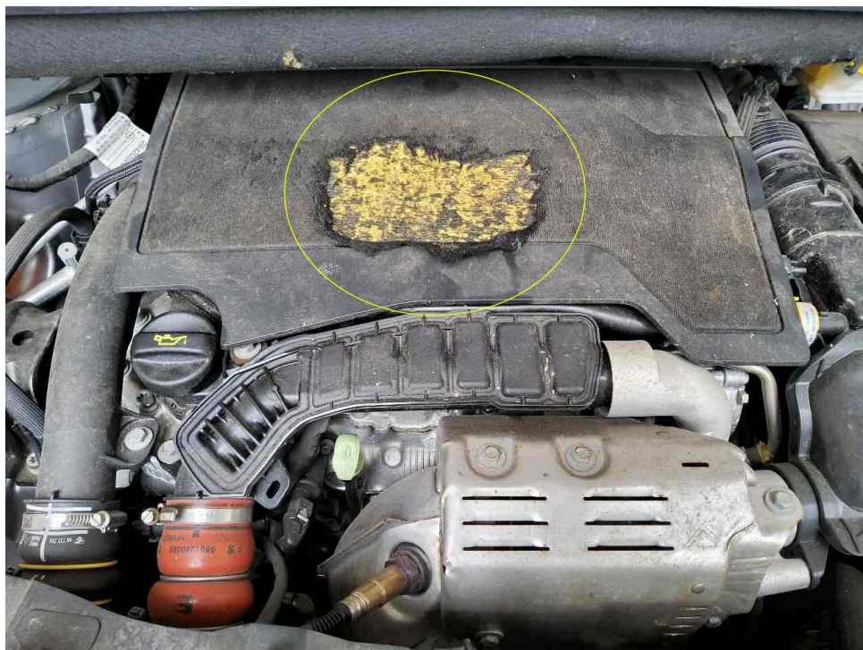
Bild 16 : Abdeckung Motor zerrissen
