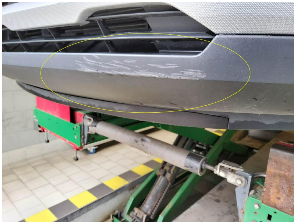
Bild 13 : Spoiler Stoßfänger vorne verschrammt
