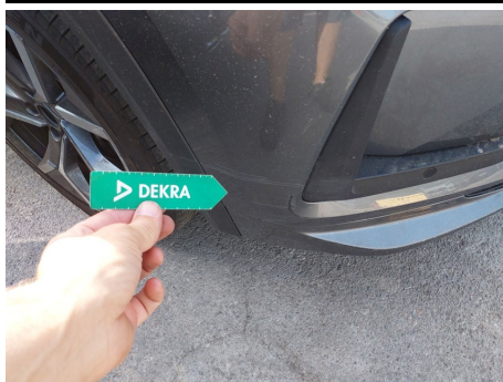
Paragolpes / Delantero / Abolladura
