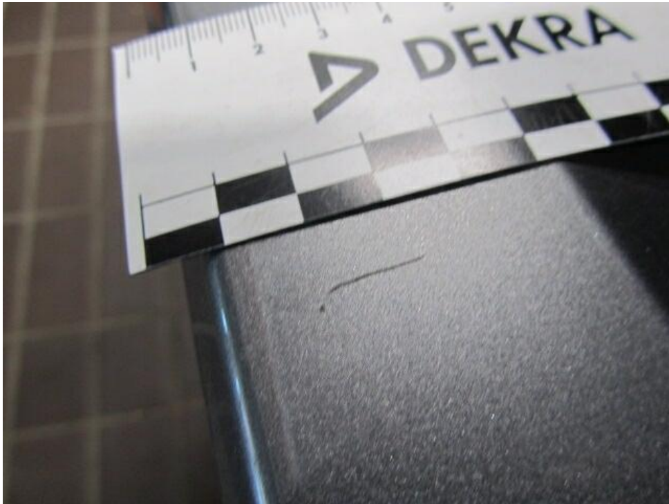
Bild 17 : Stoßfänger hinten Lackierung, verschrammt, smart repair
