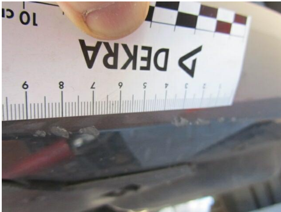
Bild 15 : Stoßfänger vorne Lackierung, verschrammt, lackieren mit Lackaufbau
