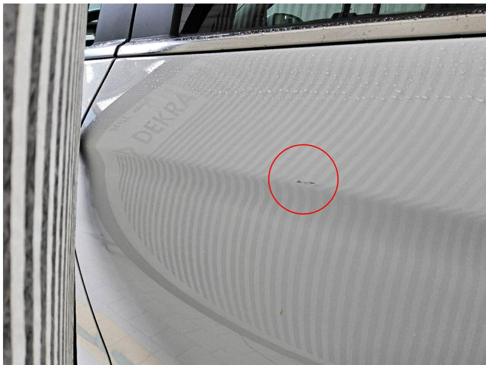
Bild 16 : Tür hinten links Lackierung oberhalb, zerkratzt, smart repair
