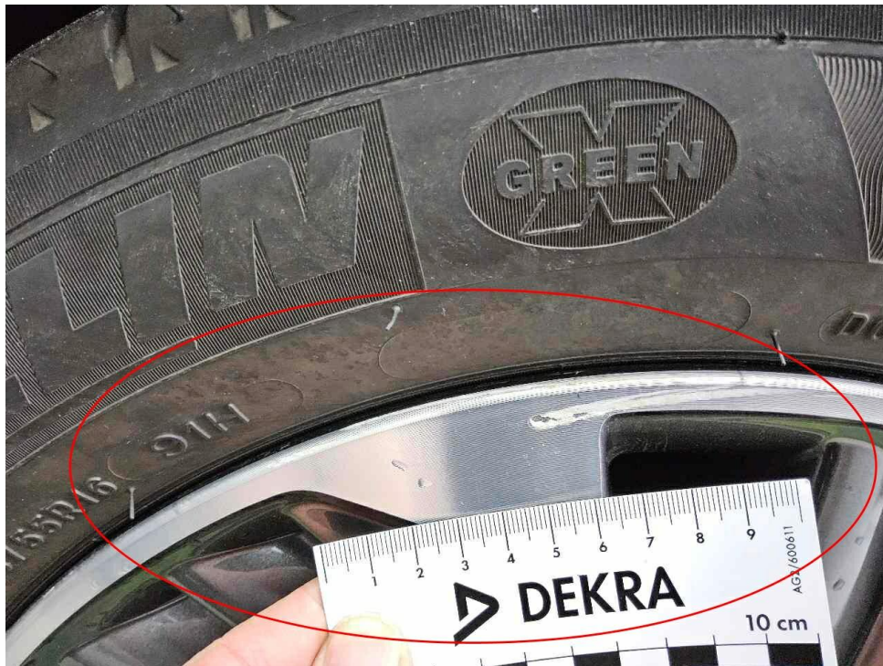
Bild 15 : Glanzgedrehte Leichtmetallfelge hinten rechts verschrammt
