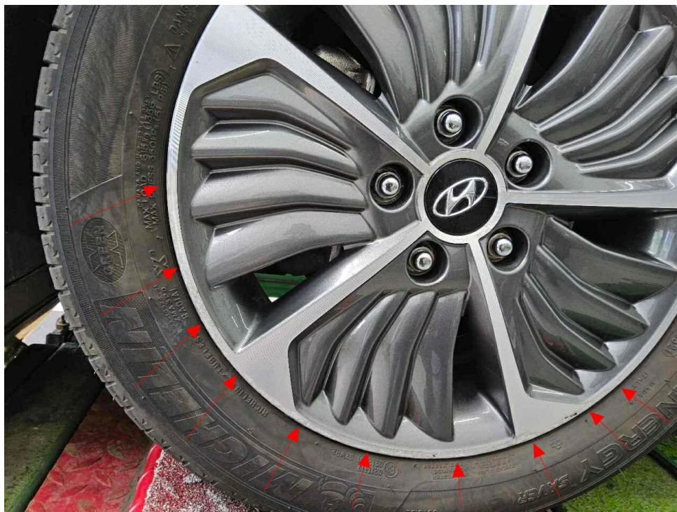
Bild 14 : Glanzgedrehte Leichtmetallfelge vorne links mit Klarlackunterwanderung
