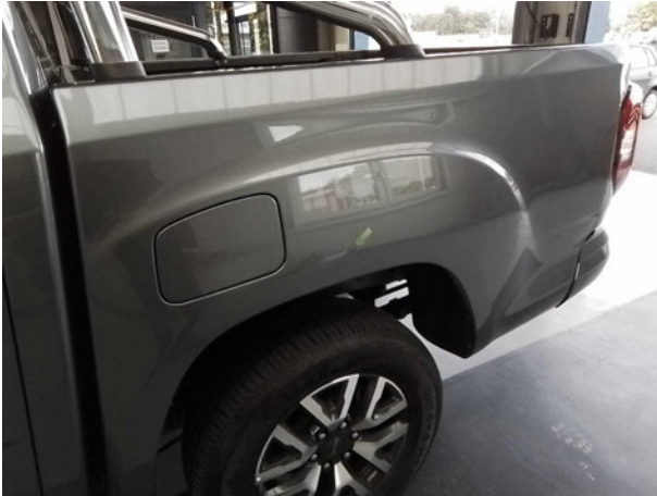
Beschädigung #1: Seitenwand links: Seitenwand - Delle(n) - sanft instandsetzen
