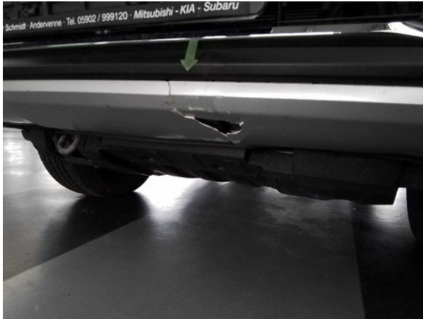
Beschädigung #3: Stossfänger vorn: Spoiler - gebrochen / gerissen - erneuern
