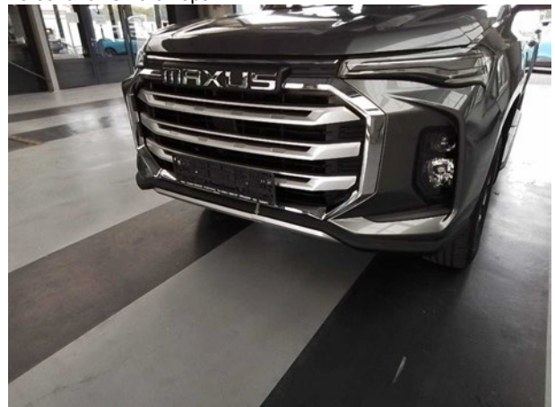
Beschädigung #3: Stossfänger vorn: Spoiler - gebrochen / gerissen - erneuern
