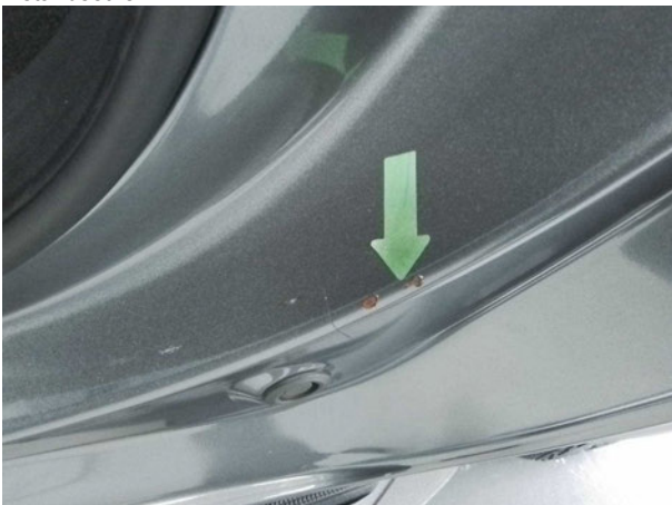
Beschädigung #2: Seitenwand links: Einstieg - verkratzt / verschürft - Smart Repair
