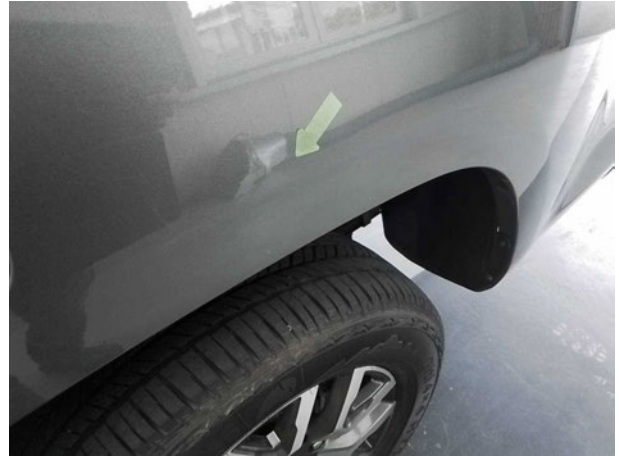
Beschädigung #1: Seitenwand links: Seitenwand - Delle(n) - sanft instandsetzen
