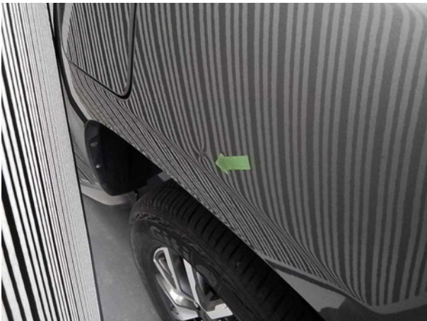
Beschädigung #1: Seitenwand links: Seitenwand - Delle(n) - sanft instandsetzen
