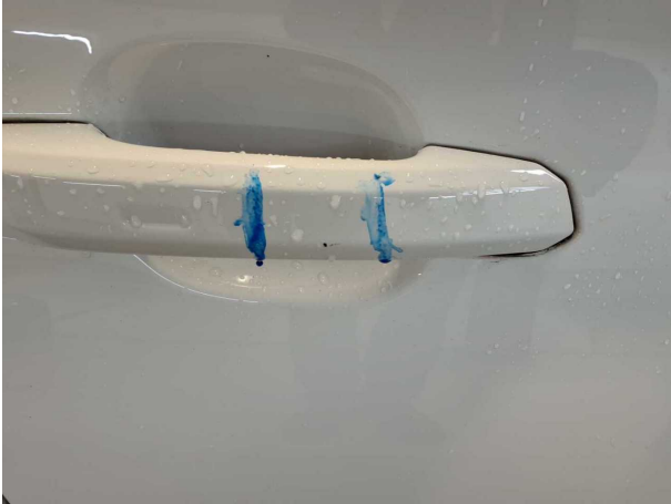
Beschädigung #3: Tür hinten rechts: Griff außen - verkratzt / verschürft - Smart Repair
