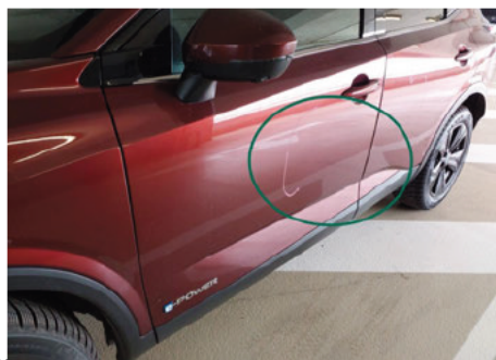
Tür / Vorne Links / Delle
