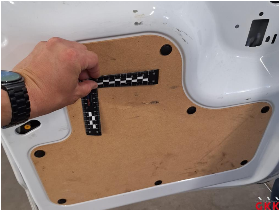
Bild 15 Hecktür links, Innenverkleidung, beschädigt, ersetzen
