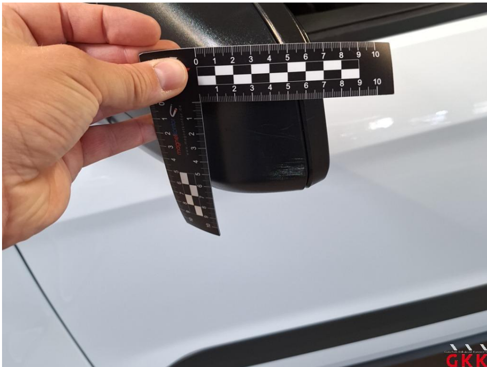
Bild 28 Spiegelgehäuse links, Kappe -unlackiert-, verkratzt, ersetzen
