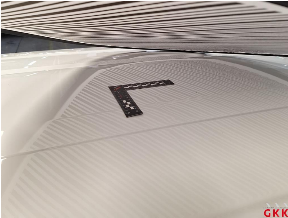
Bild 23 Dach, beschädigt, instand setzen - lackieren
