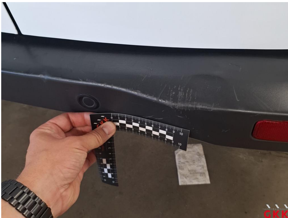
Bild 26 Stoßfänger hinten, Verkleidung -unlackiert-, beschädigt, ersetzen
