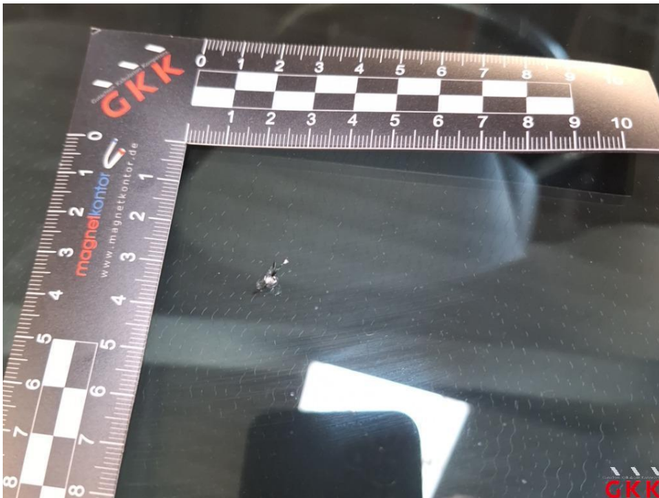
Bild 18 Frontscheibe, Steinschlag im Sichtfeld, ersetzen
