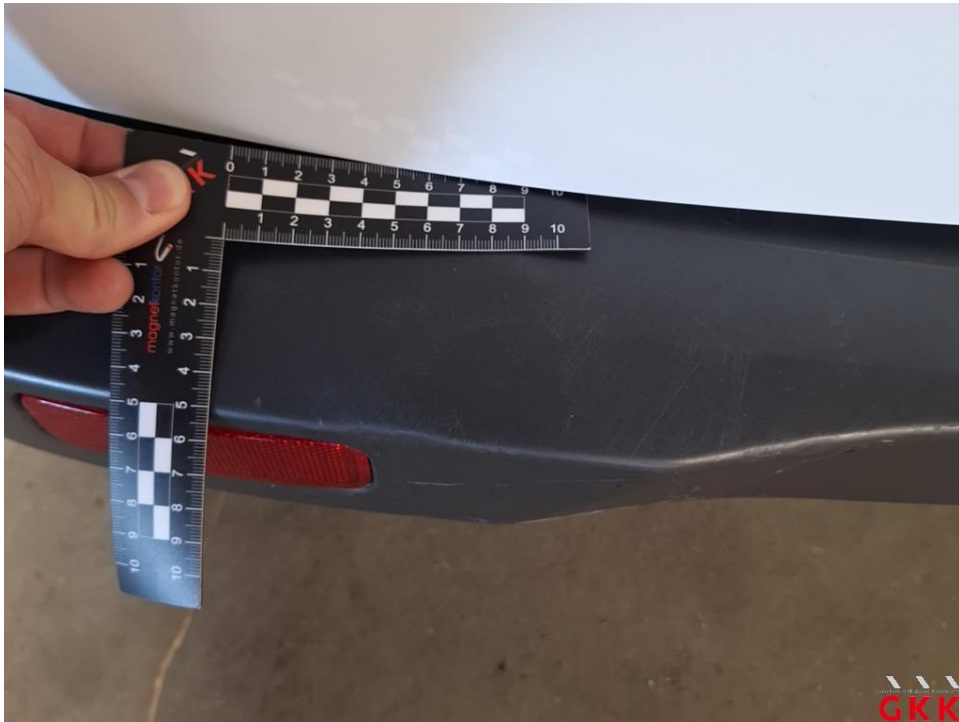
Bild 27 Stoßfänger hinten, Verkleidung -unlackiert-, beschädigt, ersetzen
