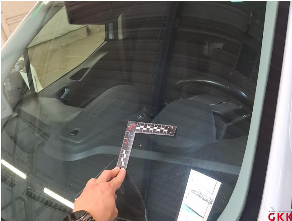
Bild 17 Frontscheibe, Steinschlag im Sichtfeld, ersetzen
