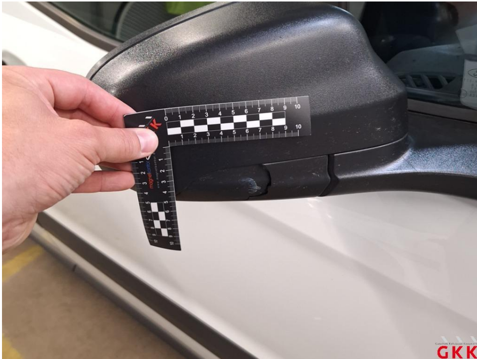
Bild 19 Spiegelgehäuse rechts, unlackiert, gerissen, ersetzen
