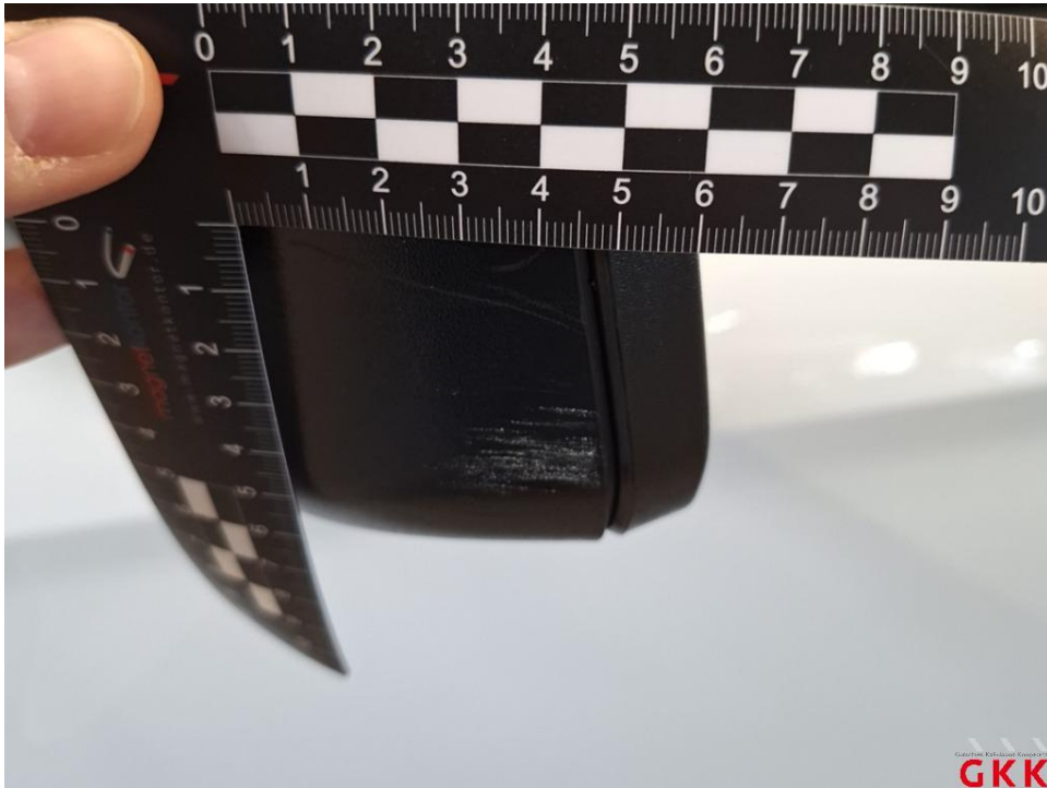
Bild 29 Spiegelgehäuse links, Kappe -unlackiert-, verkratzt, ersetzen
