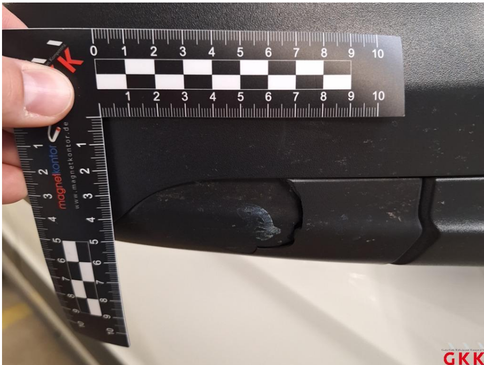
Bild 20 Spiegelgehäuse rechts, unlackiert, gerissen, ersetzen
