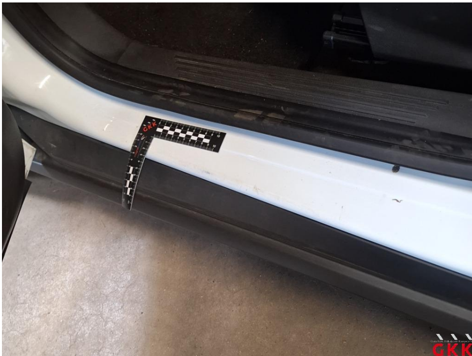
Bild 30 Tür vorne links, Einstieg, verkratzt, Smartrepair
