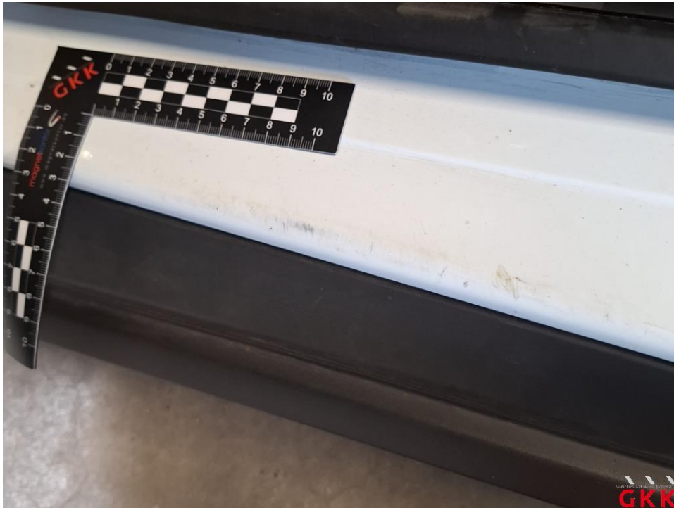
Bild 31 Tür vorne links, Einstieg, verkratzt, Smartrepair
