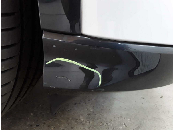
Beschädigung #4: Stossfänger vorn: Spoiler - verkratzt / versch... - lackieren
