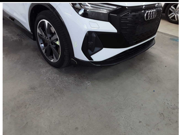
Beschädigung #4: Stossfänger vorn: Spoiler - verkratzt / verschürft - lackieren
