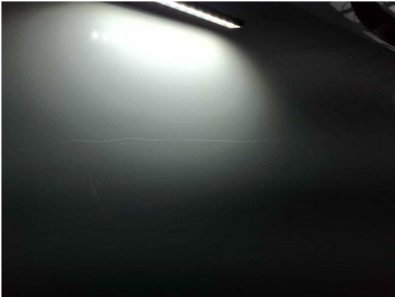
Beschädigung #6: Schiebetür rechts: Schiebetür mit Glasscheibe - Delle / Lackschaden - Smart Repair
