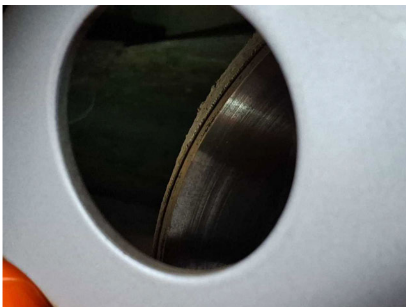
Beschädigung #12: Bremsanlage: Bremsscheiben und Beläge hinten (Riefig) - beschädigt - erneuern
