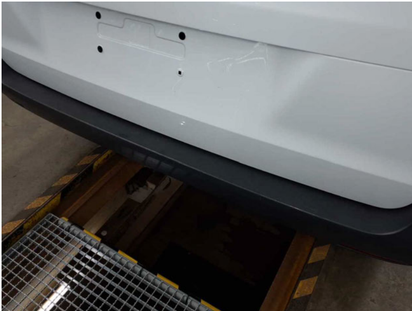
Beschädigung #13: Stossfänger hinten: Stossfänger hinten - Kratzer - erneuern
