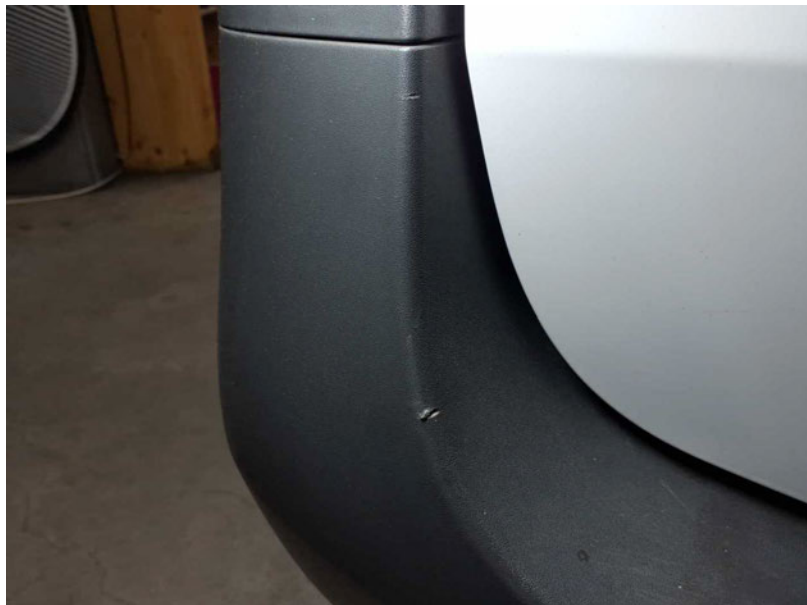
Beschädigung #13: Stossfänger hinten: Stossfänger hinten - Kratzer - erneuern
