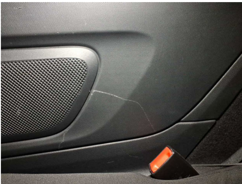
Beschädigung #7: Seitenwand rechts: Innenverkleidung - Kratzer - Wertminderung
