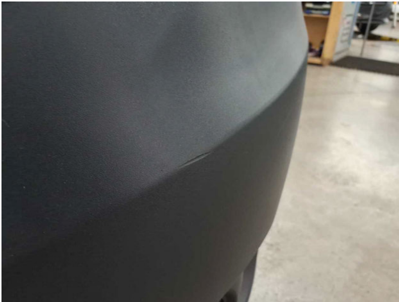
Beschädigung #8: Karosserie: Karosserie - Delle / Lackschaden - Wertminderung
