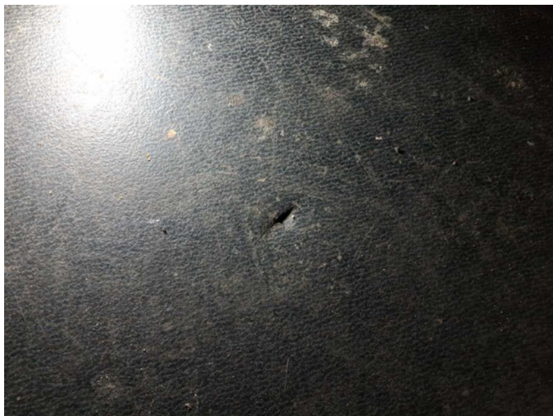
Beschädigung #9: Verkleidungen/Abdeckungen: Bodenbelag hinten - gebrochen / gerissen - Wertminderung
