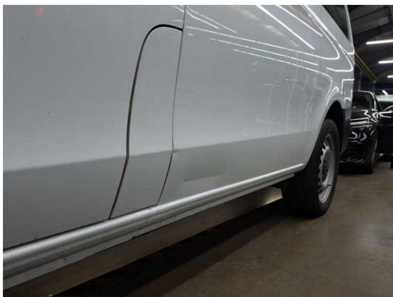
Beschädigung #14: Seitenwand links: Seitenwand - Delle(n) - instandsetzen und lackieren
