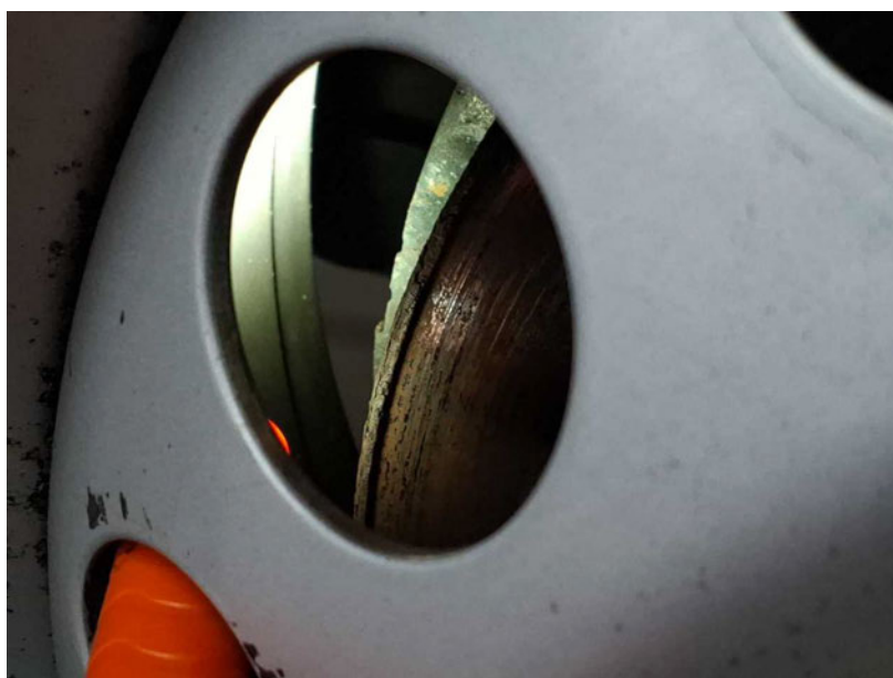
Beschädigung #10: Bremsanlage: Bremsscheiben und Beläge vorn - verschlissen - erneuern
