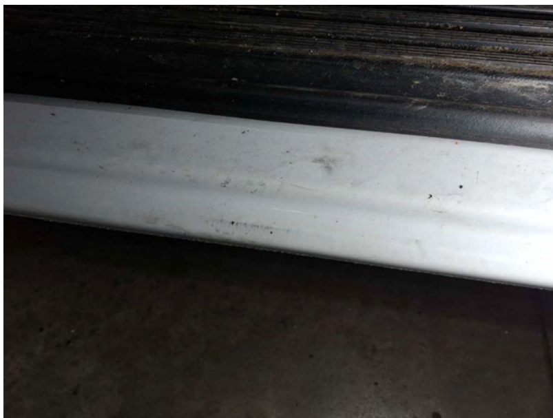
Beschädigung #11: Karosserie: B-Säule links (+ Einstieg) - Kratzer - lackieren
