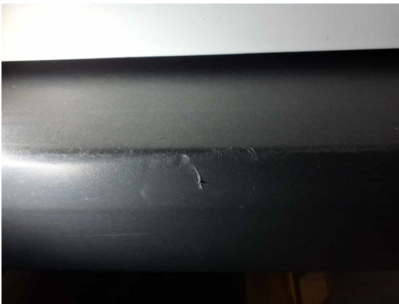
Beschädigung #13: Stossfänger hinten: Stossfänger hinten - Kratzer - erneuern
