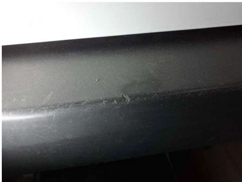
Beschädigung #13: Stossfänger hinten: Stossfänger hinten - Kratzer - erneuern
