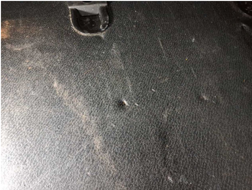
Beschädigung #9: Verkleidungen/Abdeckungen: Bodenbelag hinten - gebrochen / gerissen - Wertminderung
