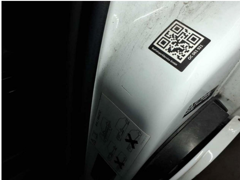
Beschädigung #11: Karosserie: B-Säule links (+ Einstieg) - Kratzer - lackieren
