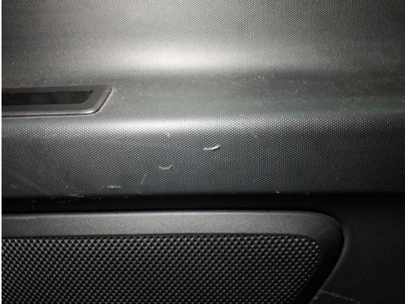
Beschädigung #7: Seitenwand rechts: Innenverkleidung - Kratzer - Wertminderung
