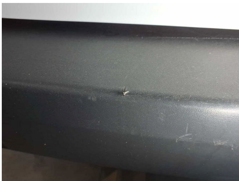
Beschädigung #13: Stossfänger hinten: Stossfänger hinten - Kratzer - erneuern
