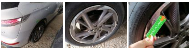
Alloy rim FR, Scratch(es), Repair/replace (lump sum)
