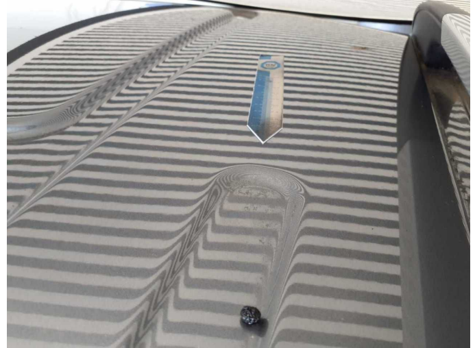
Damage 6: Roof: Roof (Anätzung-Mehrkosten möglich) - Paint defect - Conditioning
