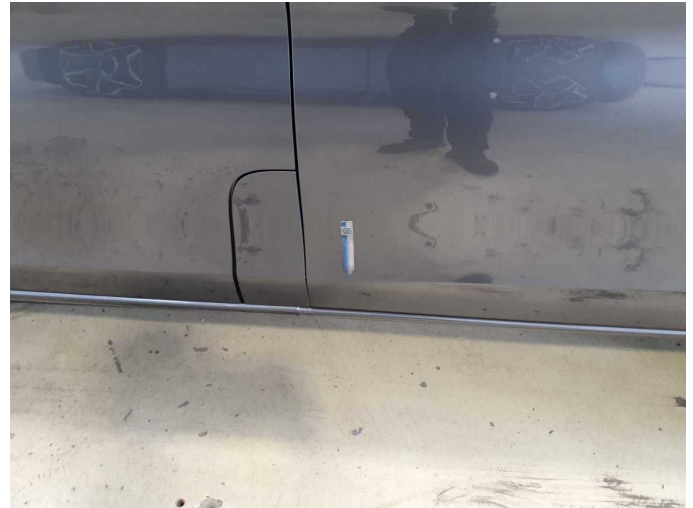
Damage 7: Side panel - rear left side: Side panel (Läufer-Mehrkosten möglich) - Unprofessionally repaired - Conditioning
