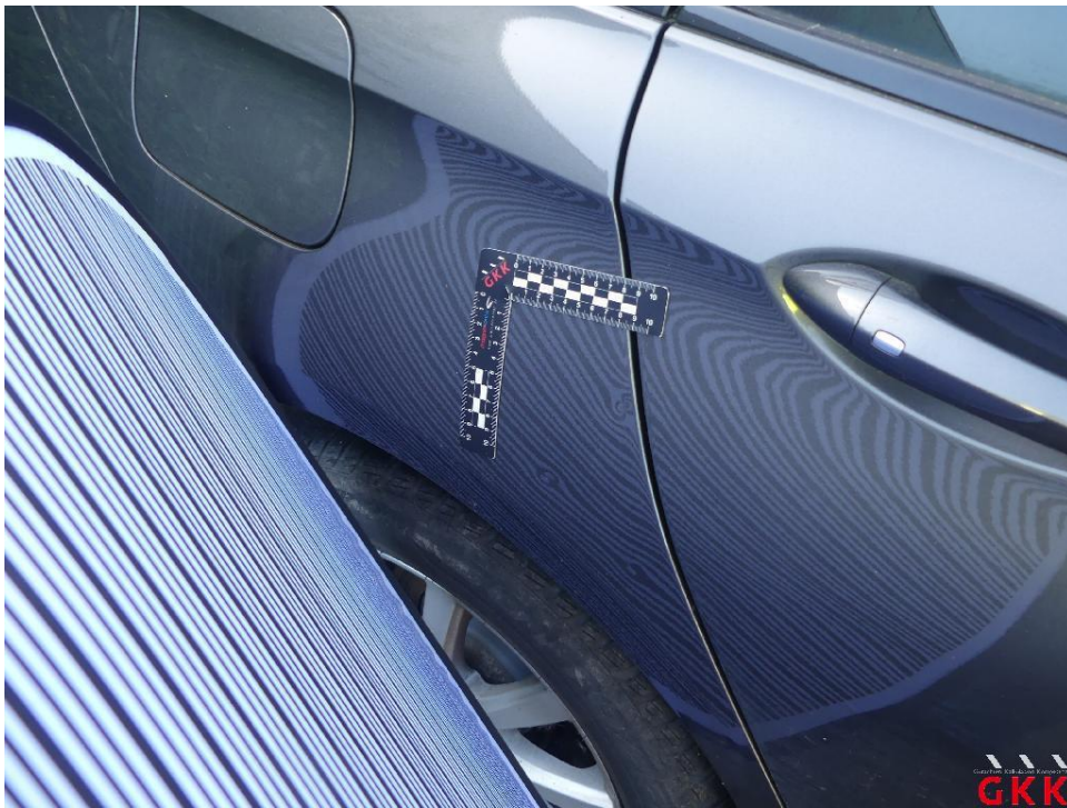
Bild 30 Seitenwand rechts, beschädigt, instand setzen - lackieren
