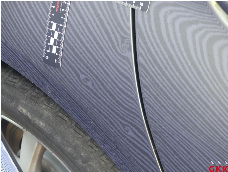
Bild 32 Seitenwand rechts, beschädigt, instand setzen - lackieren
