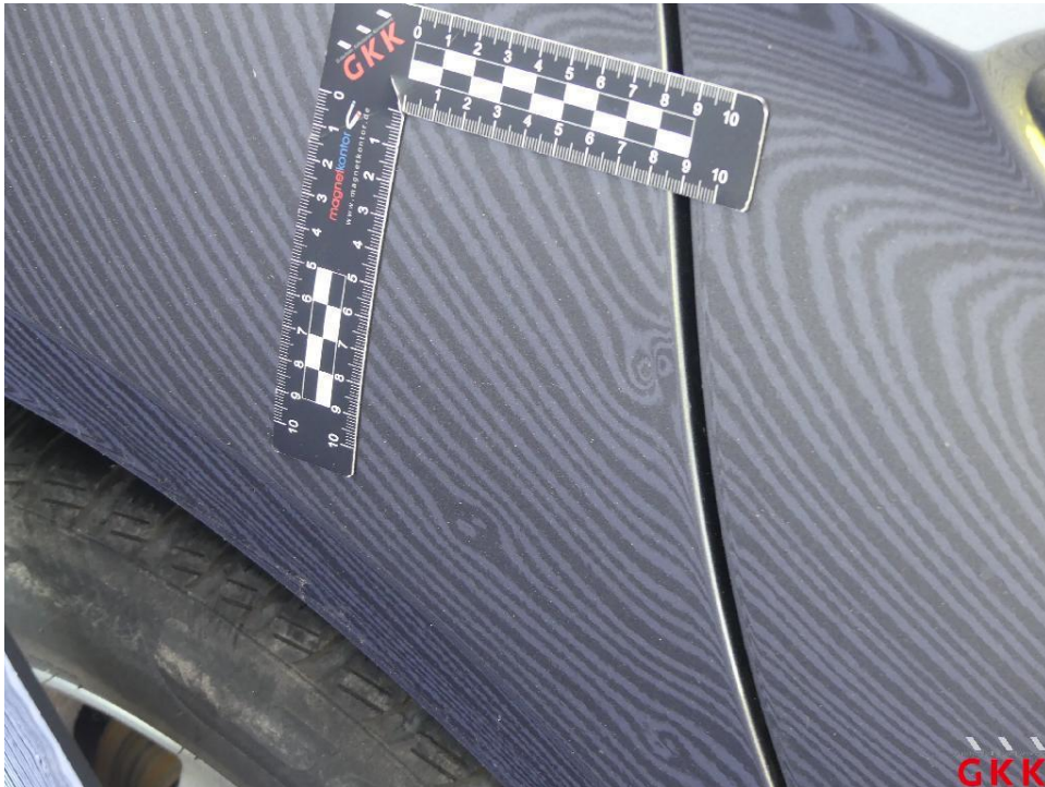
Bild 31 Seitenwand rechts, beschädigt, instand setzen - lackieren
