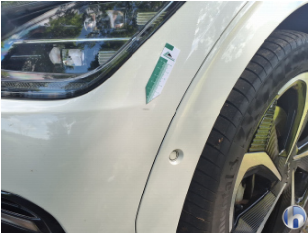
1. Stoßfänger Vorne Oberflächenkratzer - Aufbereiten / Polieren
