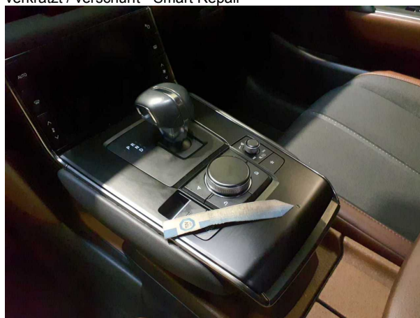
Beschädigung #3: Verkleidungen/Abdeckungen: Zierleiste / Dekorleiste - beschädigt - erneuern
