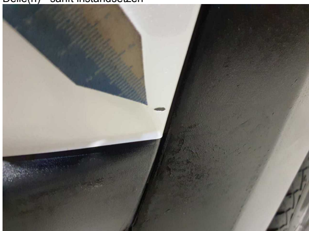
Beschädigung #2: Stoßfänger vorn: Stoßfänger vorn links - verkratzt / verschürft - Smart Repair
