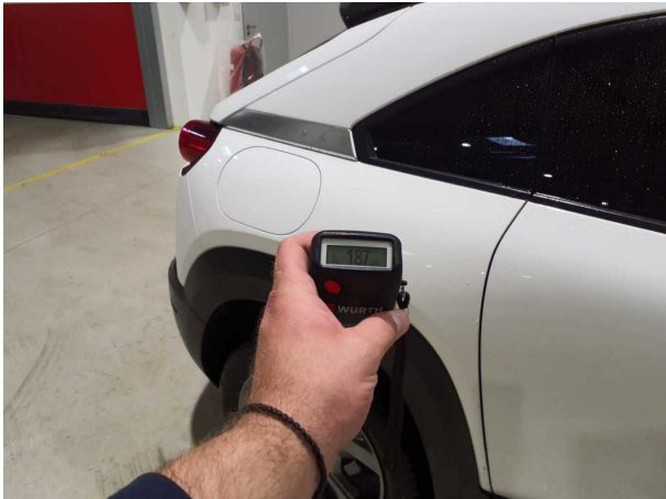
Nachlackierung 1: Seitenwand rechts
