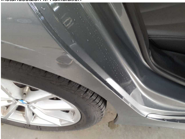
Beschädigung #7: Karosserie: Karosserie - beschädigt - instandsetzen lt. Kalkulation
