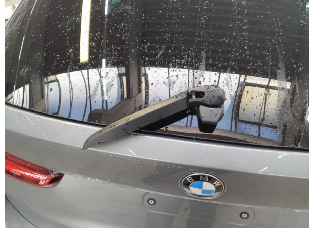
Beschädigung #5: Scheibenreinigung: Scheibenwischerarm hinten - beschädigt - erneuern
