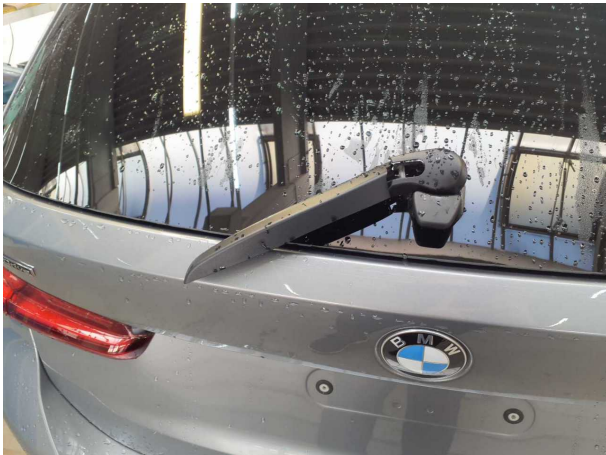
Beschädigung #1: Scheibenreinigung: Scheibenwischerblatt hinten - fehlt - erneuern
