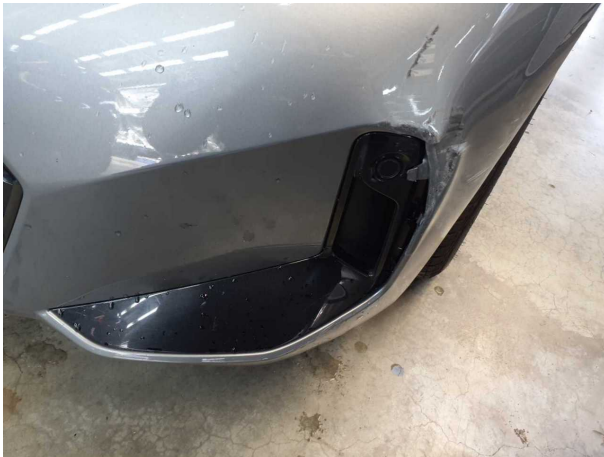
Beschädigung #8: Karosserie: Karosserie - beschädigt - instandsetzen lt. Kalkulation
