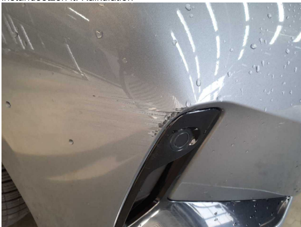
Beschädigung #8: Karosserie: Karosserie - beschädigt - instandsetzen lt. Kalkulation
