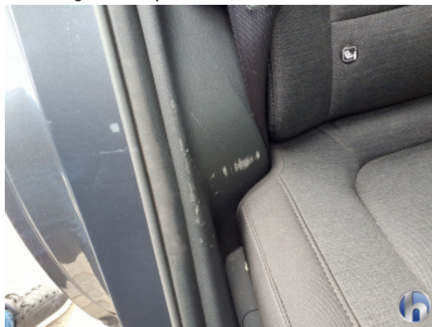
3. Verkleidung Kratzer - Smart Repair
