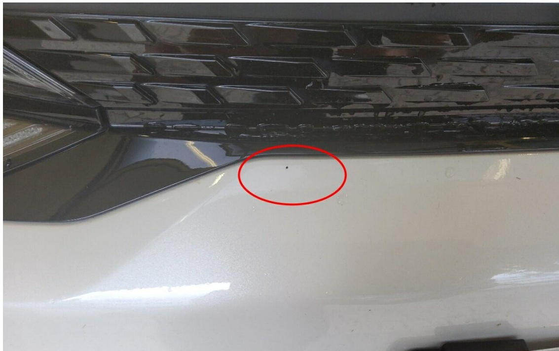
Bild 9 : Stoßfänger vorne, Steinschlag, smart repair
