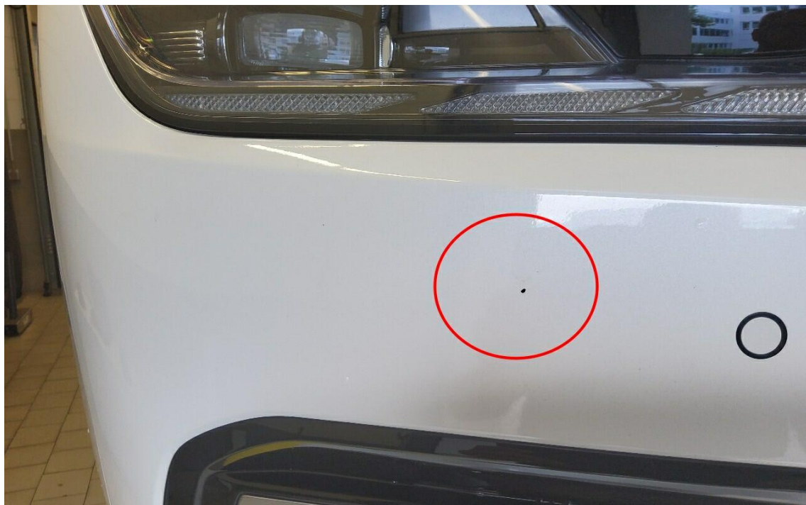
Bild 8 : Stoßfänger vorne, Steinschlag, smart repair
