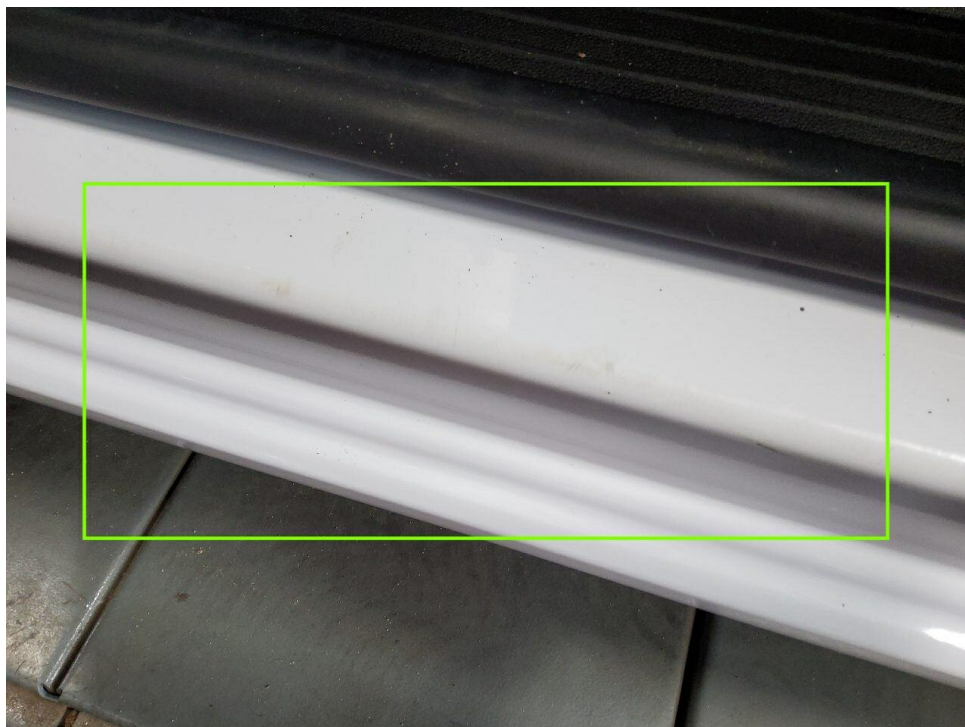
Bild 12 : Gebrauchsspur: Einstieg vorne links verkratzt
