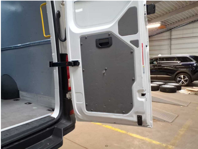
Damage 3: Boot lid / rear door: Trim rear door - hard fibre - lower (Rechts) - Broken / torn - Replace
