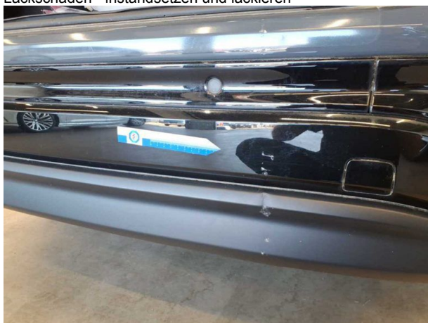
Beschädigung #7: Stossfänger hinten: Stossfänger mit Parktroni... Delle / Lackschaden - instandsetzen und lackieren
