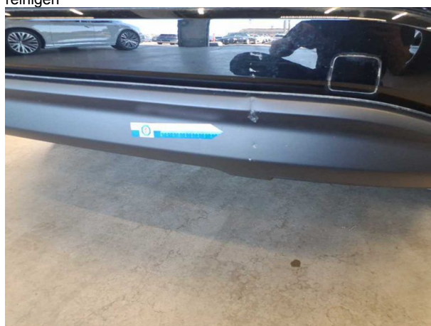
Beschädigung #5: Stossfänger hinten: Spoiler - verformt - erneuern
