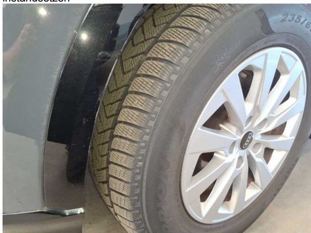
Beschädigung #2: Kotflügel links: Radhausverbreiterung - Kratzer - Smart Repair
