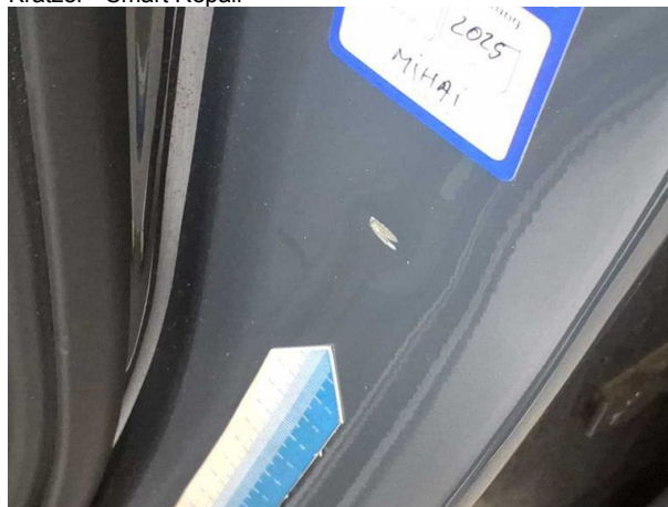
Beschädigung #3: Karosserie: B-Säule links - Delle / Lackschaden - Smart Repair
