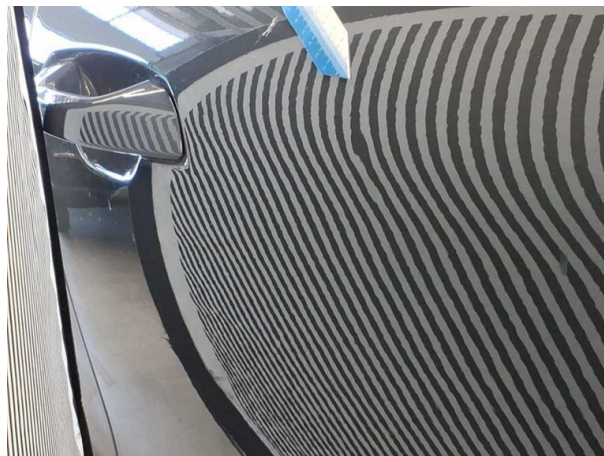
Beschädigung #1: Tür vorn rechts: Tür - Delle(n) - sanft instandsetzen
