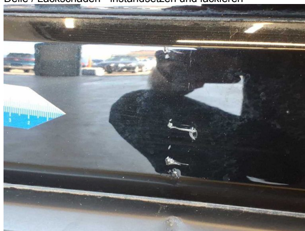
Beschädigung #7: Stossfänger hinten: Stossfänger mit Parktronic - Delle / Lackschaden - instandsetzen und lackieren
