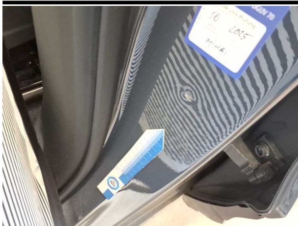
Beschädigung #3: Karosserie: B-Säule links - Delle / Lackschad... - Smart Repair
