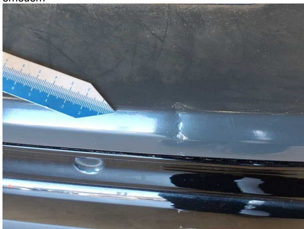
Beschädigung #6: Stossfänger hinten: Stossfänger hinten - Delle / Lackschaden - instandsetzen und lackieren
