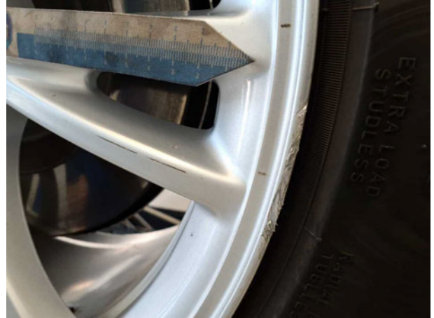
Beschädigung #1: Rad/Reifen: Leichtmetallfelge vorn rechts (Winterradsatz) - Kratzer - Wertminderung
