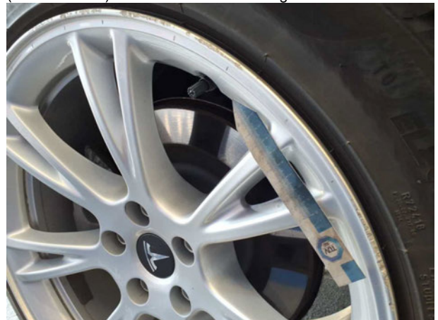
Beschädigung #2: Rad/Reifen: Leichtmetallfelge hinten rechts - Kratzer - erneuern
