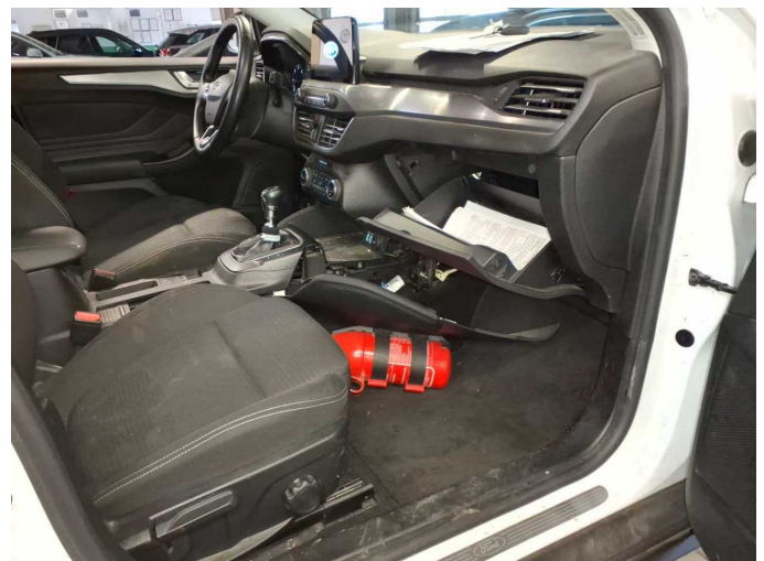
Damage 11: Instrument panel: Centre console - front (Verkleidung rechts, Nasen gebrochen, evtl Mehrkosten) - Loose - Replace
