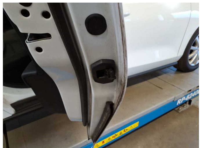
Damage 5: Door - rear right side: Door edge (Kantenschutz) - Missing - Replace
