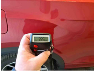
Lackstärke Seitenwand hinten rechts
