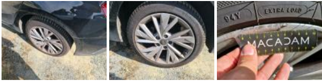
Alloy rim RR, Scratch(es), Repair/replace (lump sum)
