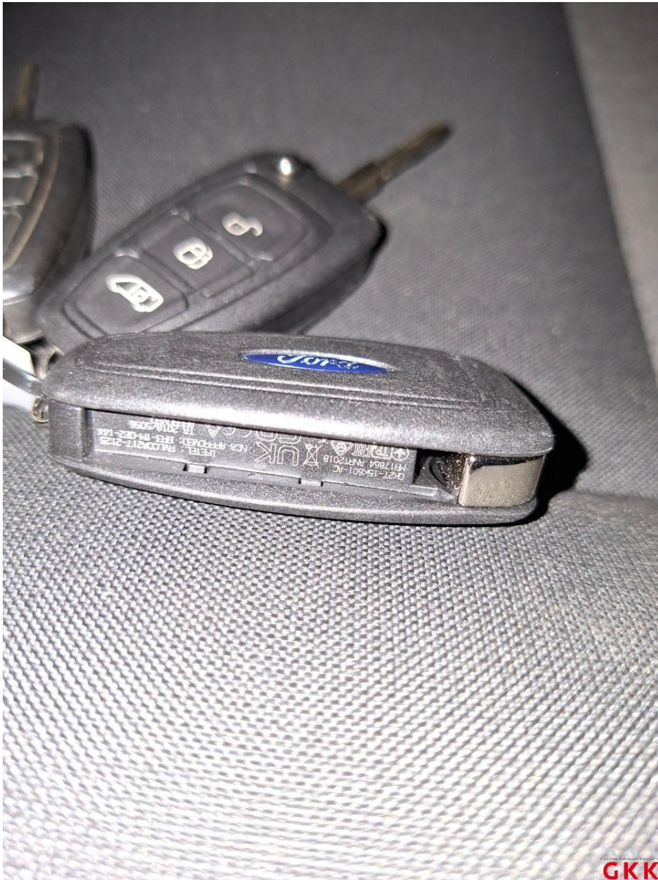
Bild 14 Hauptschlüssel, mit Fernbedienung, beschädigt, ersetzen
