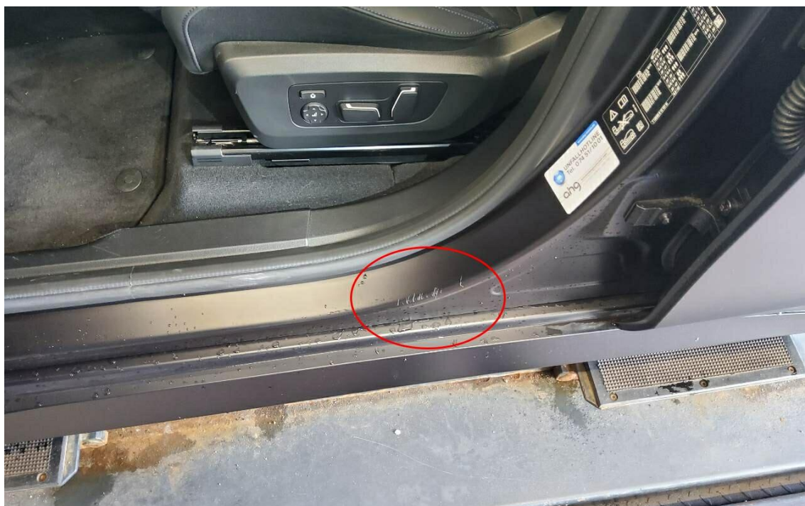
Bild 16 : Türeinstieg vorne links verkratzt
