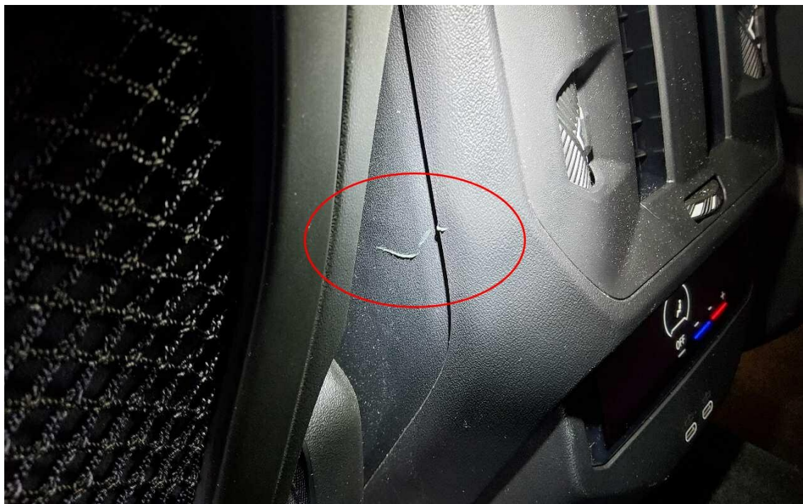
Bild 15 : Mittelkonsole hinten links Kratzer
