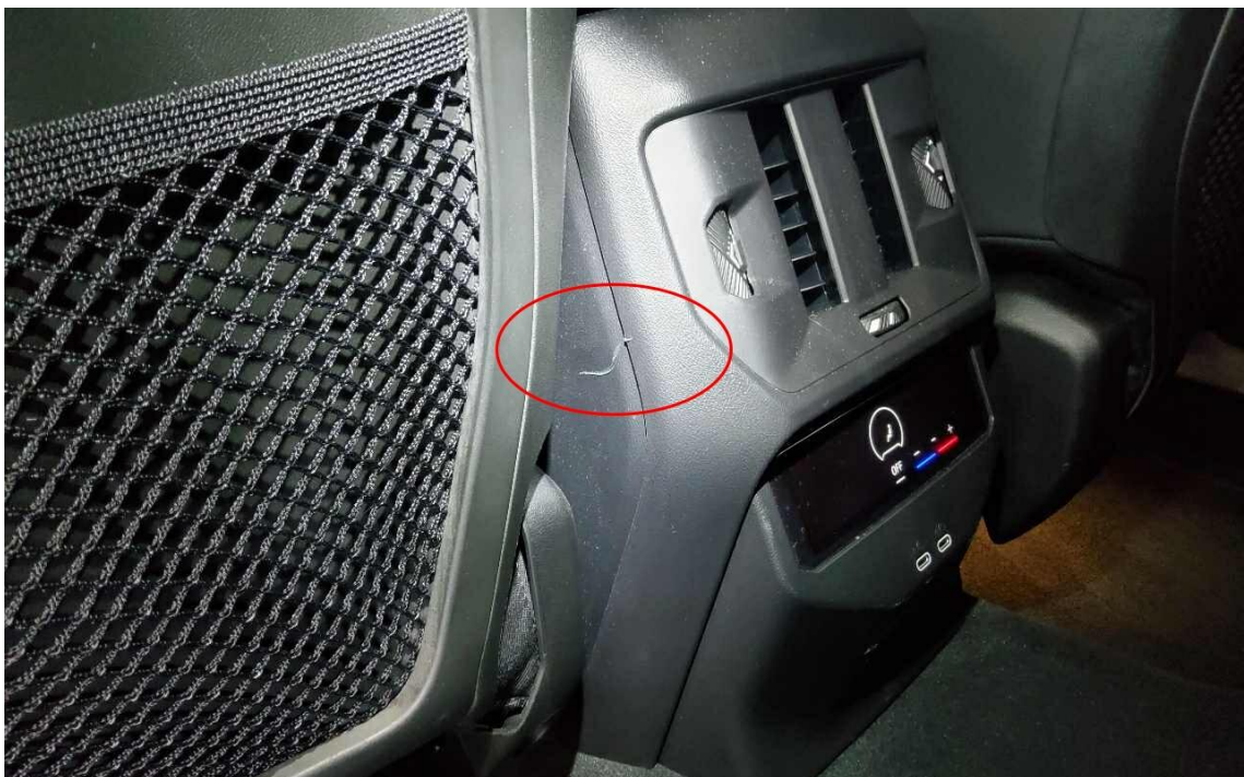
Bild 14 : Mittelkonsole hinten links Kratzer
