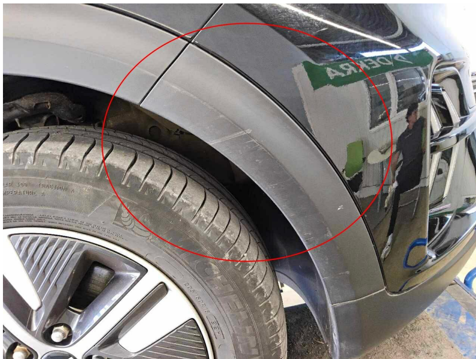
Bild 15 : Radlauf Kotflügel, verschrammt
