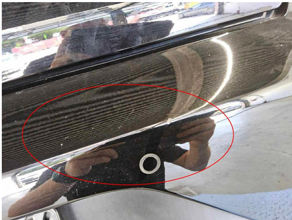
Bild 14 : Stoßfänger hinten, zerkratzt, smart repair
