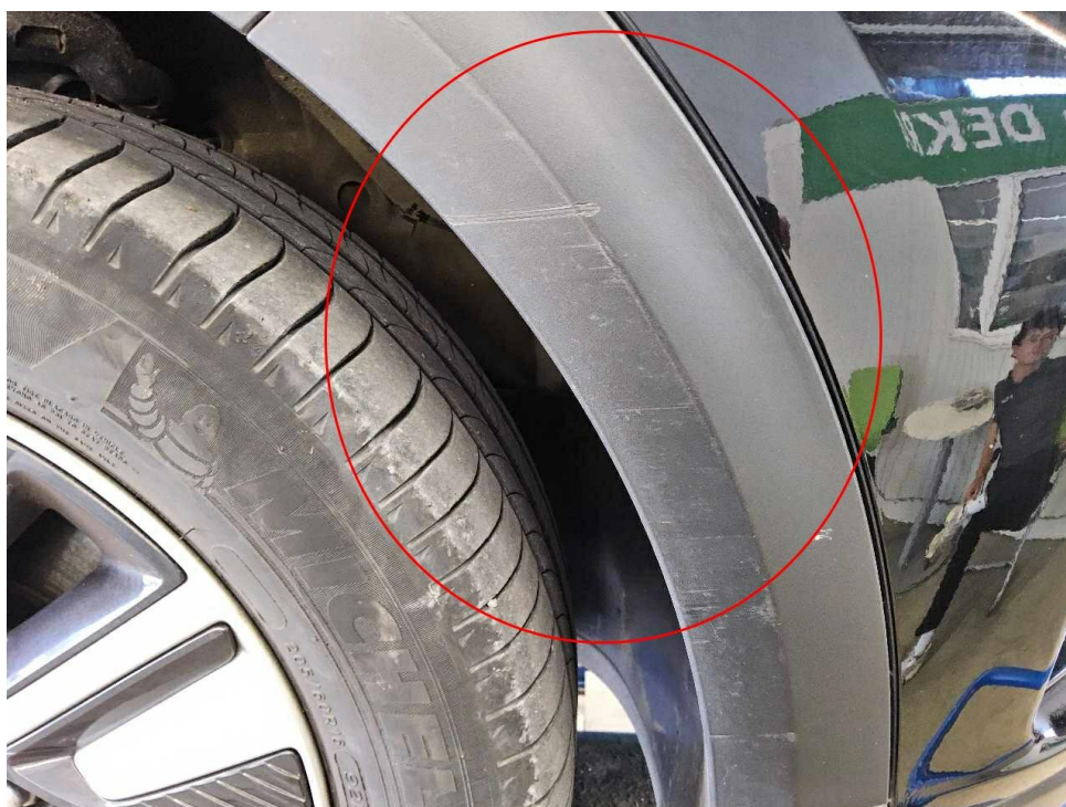
Bild 16 : Radlauf Kotflügel, verschrammt
