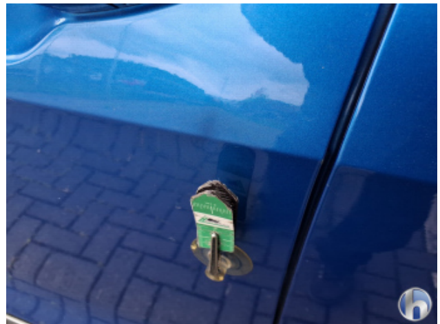
1. Tür Vorne - Links Verdellt - Sanft Instandsetzen
