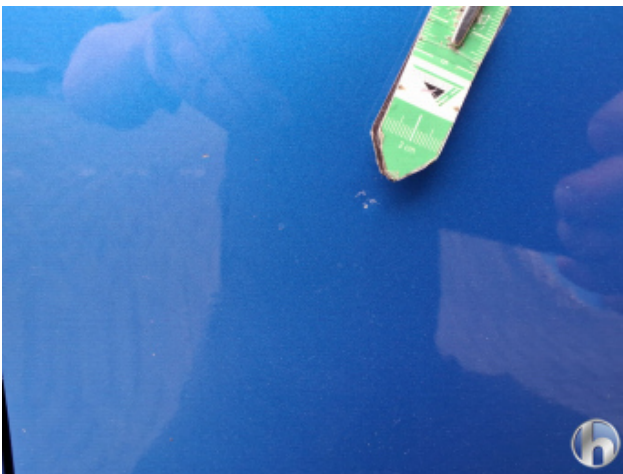
4. Tür Hinten - Links Verdellt - Sanft Instandsetzen
