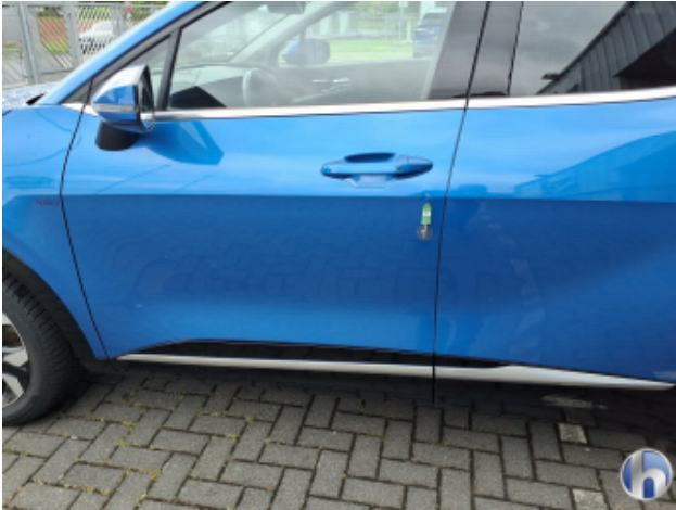
1. Tür Vorne - Links Verdellt - Sanft Instandsetzen
