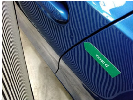
Tür / Vorne Links / Delle
