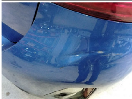
Stoßfänger oberhalb / Hinten / Delle
