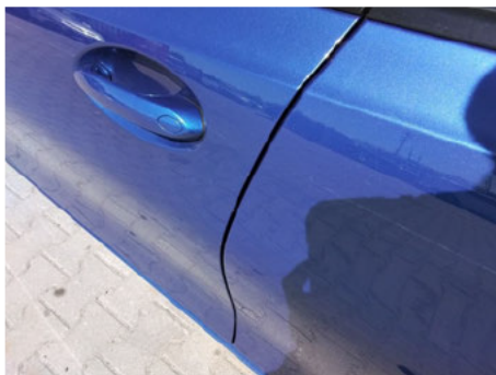
Tür / Vorne Links / Delle
