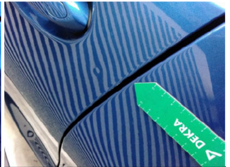
Tür / Vorne Links / Delle
