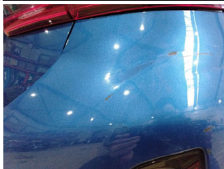
Stoßfänger oberhalb / Hinten / Delle
