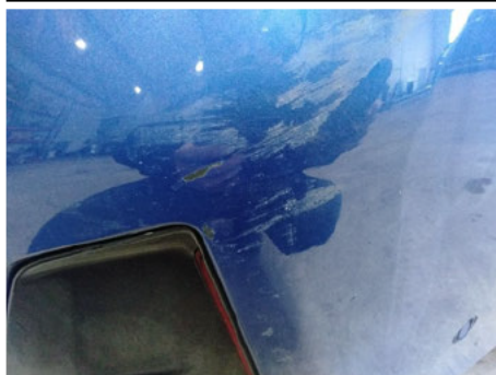
Stoßfänger oberhalb / Hinten / Delle
