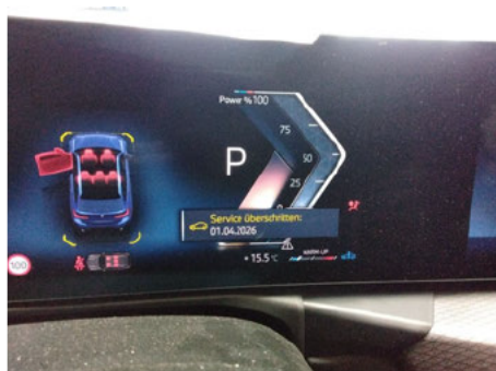
Warnleuchte Inspektion / Fehlt
