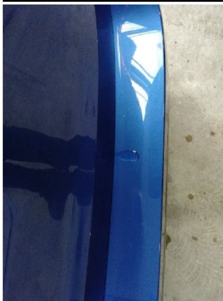
Stoßfänger oberhalb / Hinten / Delle
