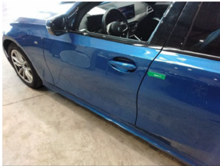
Tür / Vorne Links / Delle
