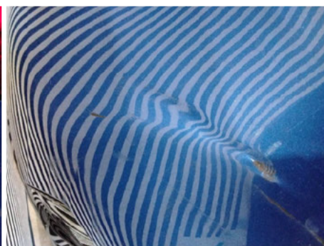
Stoßfänger oberhalb / Hinten / Delle
